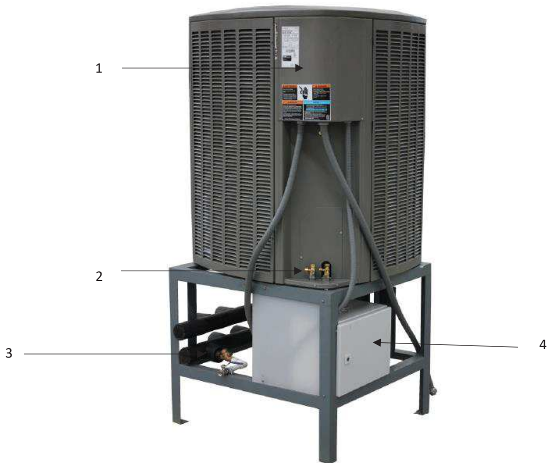
Ilustración 2.1 Unidad mini chiller de 5 toneladas. 1. Sistema de fuerza y control A419. 2. Válvulas de servicio de refrigerante. 3. Salida de agua helada. 4. Sistema de control por PLC.
