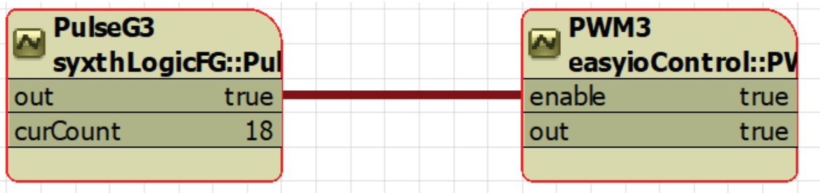
Ilustración 4.18 Programación en bloque de alarma de 1 pulso.
