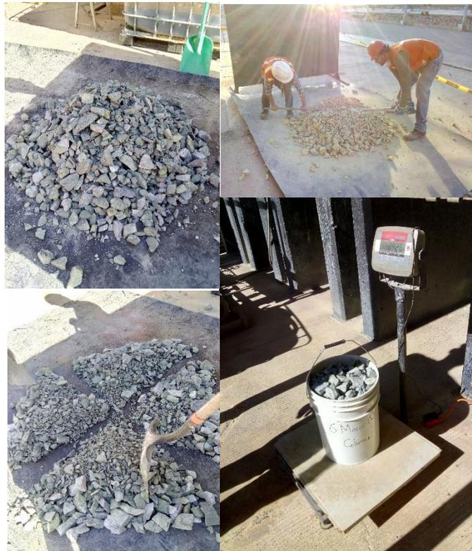
**Figura 20.** Toma de muestra de mineral de cada una de las columnas.
