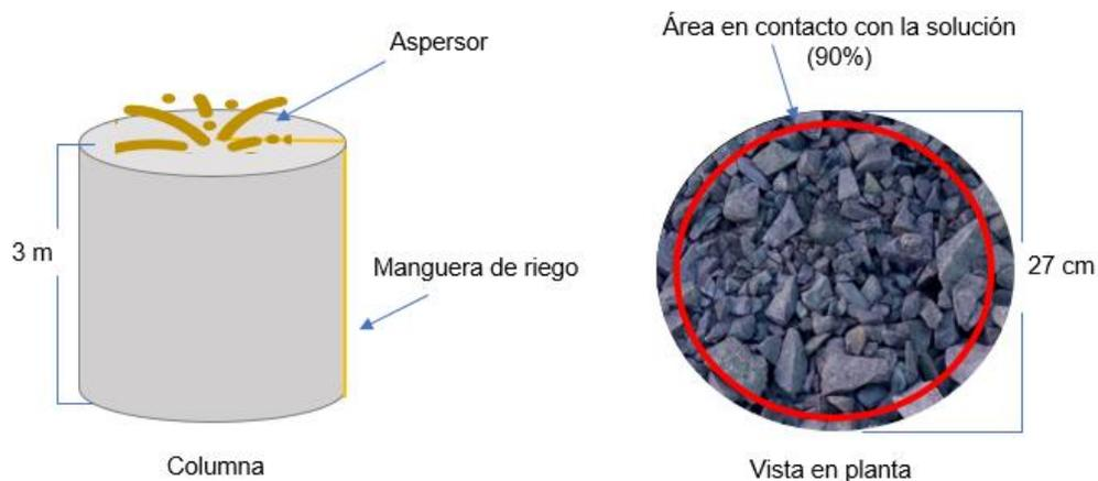
**Figura 35.** Esquema del nuevo sistema de riego.
