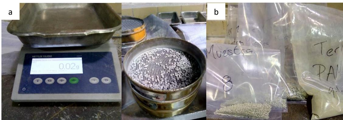
**Figura 23.** a) Masa retenida, b) Clasificación de muestras por tamaño de partícula.
