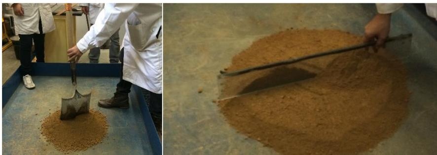
**Figura 6.** Medio cono invertido truncado.
