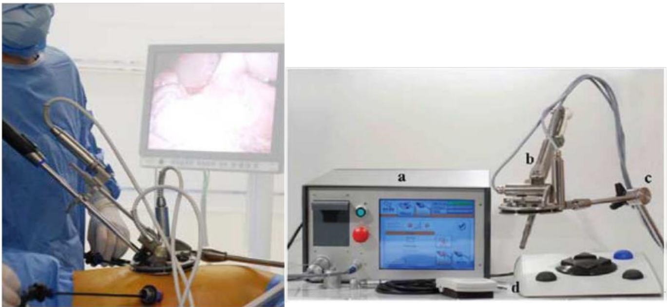
Figura 2.9 Izquierda: Robot ViKY posicionado en el cuerpo del paciente. Derecha: unidad de control de ViKY. (a) Consola, (b) robot sujetador de cámara, (c) pedal de seguridad para control de voz, (d) pedal sin control de voz.
