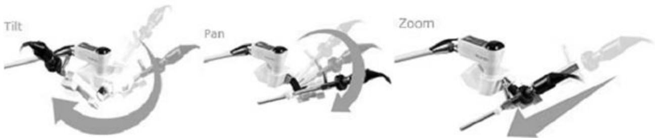
Figura 2.14 Movimientos descritos por el robot Freehand.
