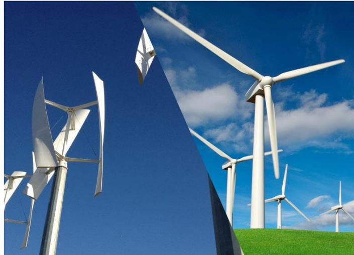
*Figura 27. Aerogeneradores de eje vertical (izquierda) y de eje horizontal (derecha).*
