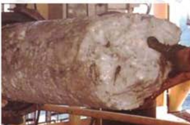
Imagen 5.7. Formación de Hidratos de Metano. (Fuente: Tomada de aseguramiento de flujo en producción submarina)
