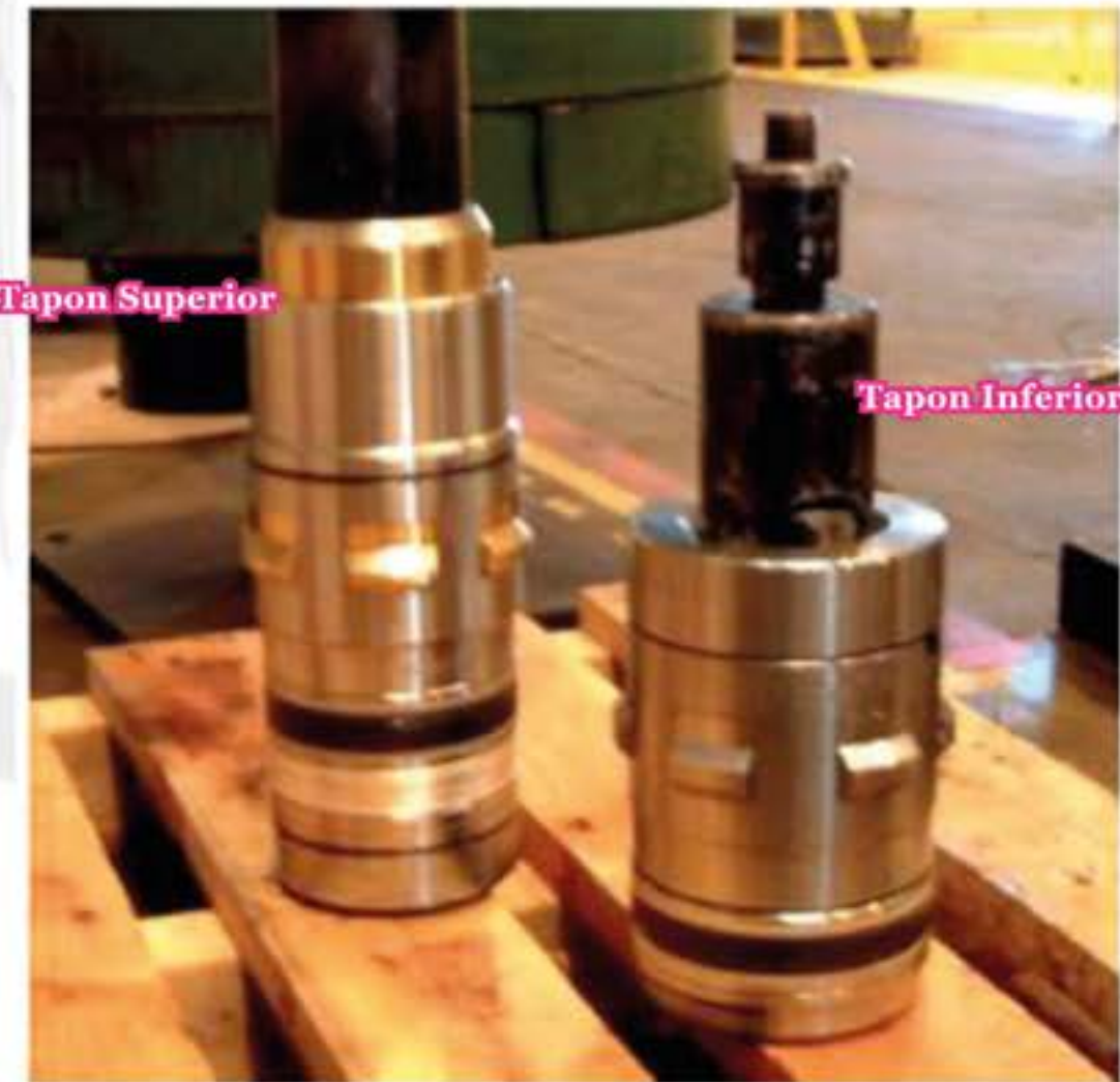
Imagen 4-55. Tipos de Taponos de Corona. (Fuente: Tomada y modificada por Gerardo de Drilling and Well Activities)
