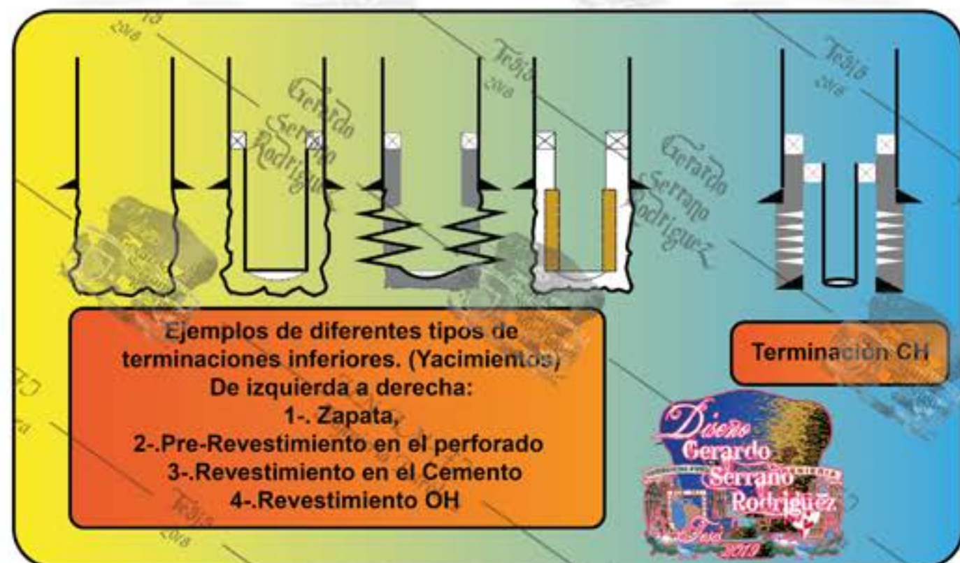
Imagen 4-45. Tipos de Diseño en la Terminación Inferior. (Fuente: Tomada y modificada por Gerardo de Drilling and Well Activities)
