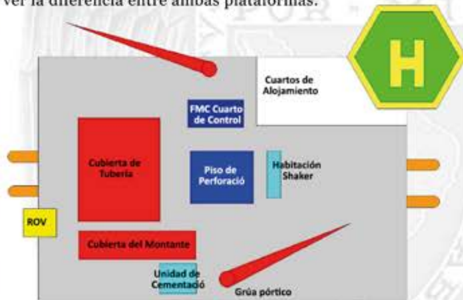
Imagen 4.8. Plataforma de Cuarta Generación. (Fuente: Tomada de equipos de perforación)
