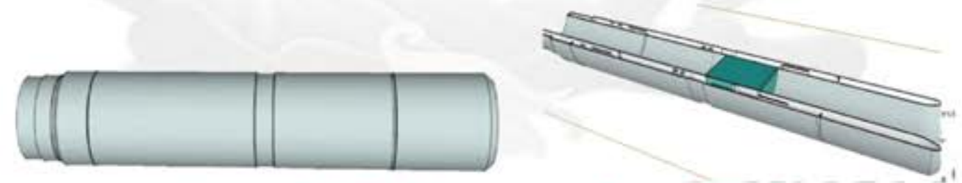
Imagen 4-51. Tapones de Vidrio. (Fuente: Tomada y modificada por Gerardo de Drilling and Well Activities)
