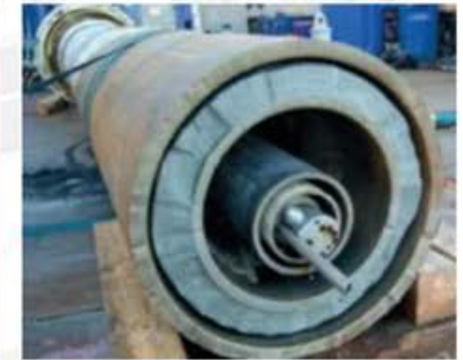
Imagen 4-79. Barreras de Aislamiento en el Espacio Anular. (Fuente: Tomada y modificada por Gerardo de Drilling and Well Activities)
