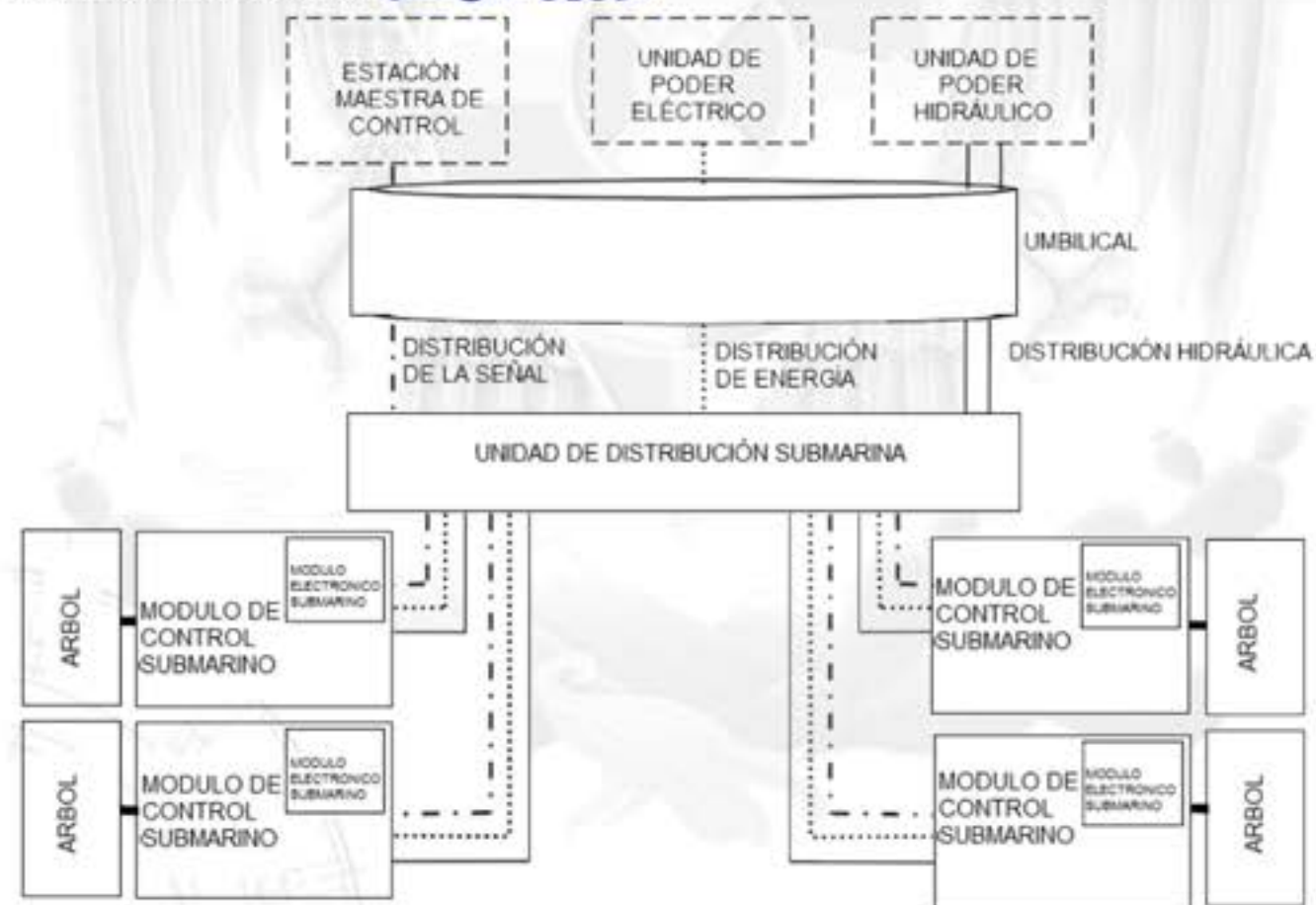
Imagen 5-75. Sistemas Multiplex Electro Hidráulico (E-HMUX).
