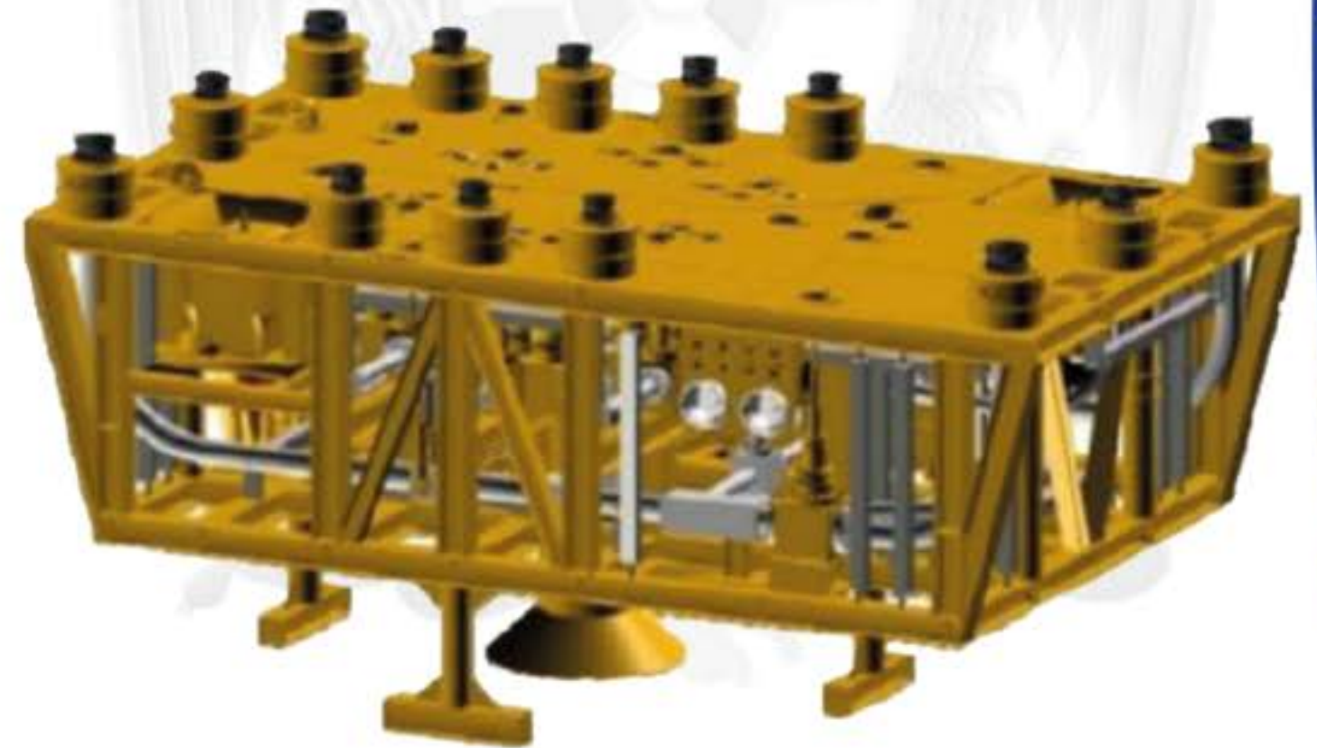
Imagen 5.37. Manifold, PLEM y Plantillas Submarinas de Producción. (Fuente: Tomada y Modificada por Gerardo de equipos de producción submarina)
