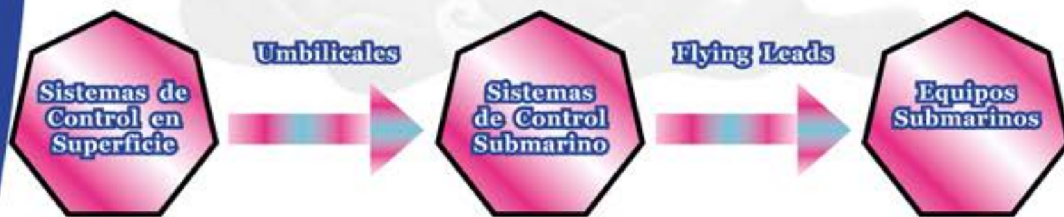
Imagen 5-56. Sistemas de Control
