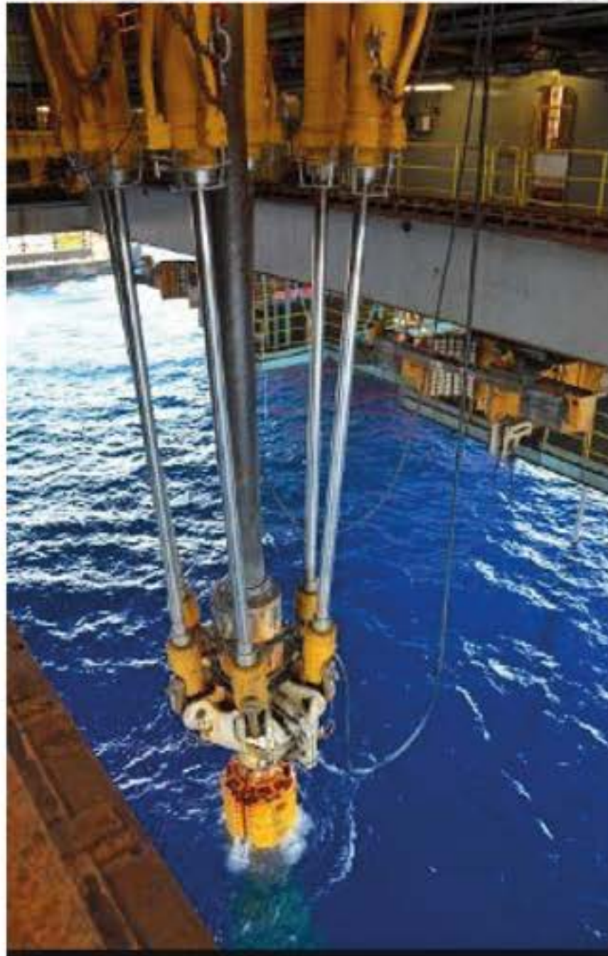
Imagen 3.51. Pozo de Sondeo o Moon-Pool. (Fuente: Tomada de Robots Submarinos ROV)
