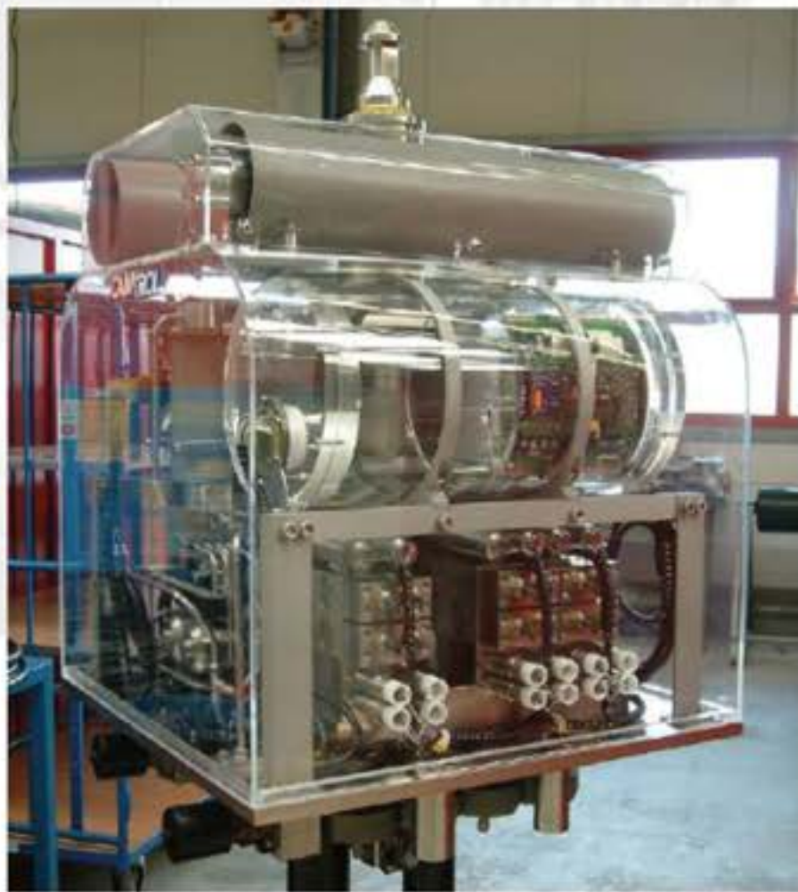
Imagen 5.70. Módulo de Control Submarino (SCM) Propiedad Cameron.
