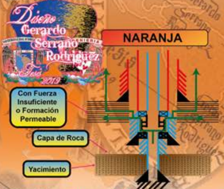
Imagen 4.23. Ejemplo de la Categorización para un Pozo Naranja y Rojo. (Fuente: Tomada y Modificada por Gerardo de Drilling and Well Activities)
