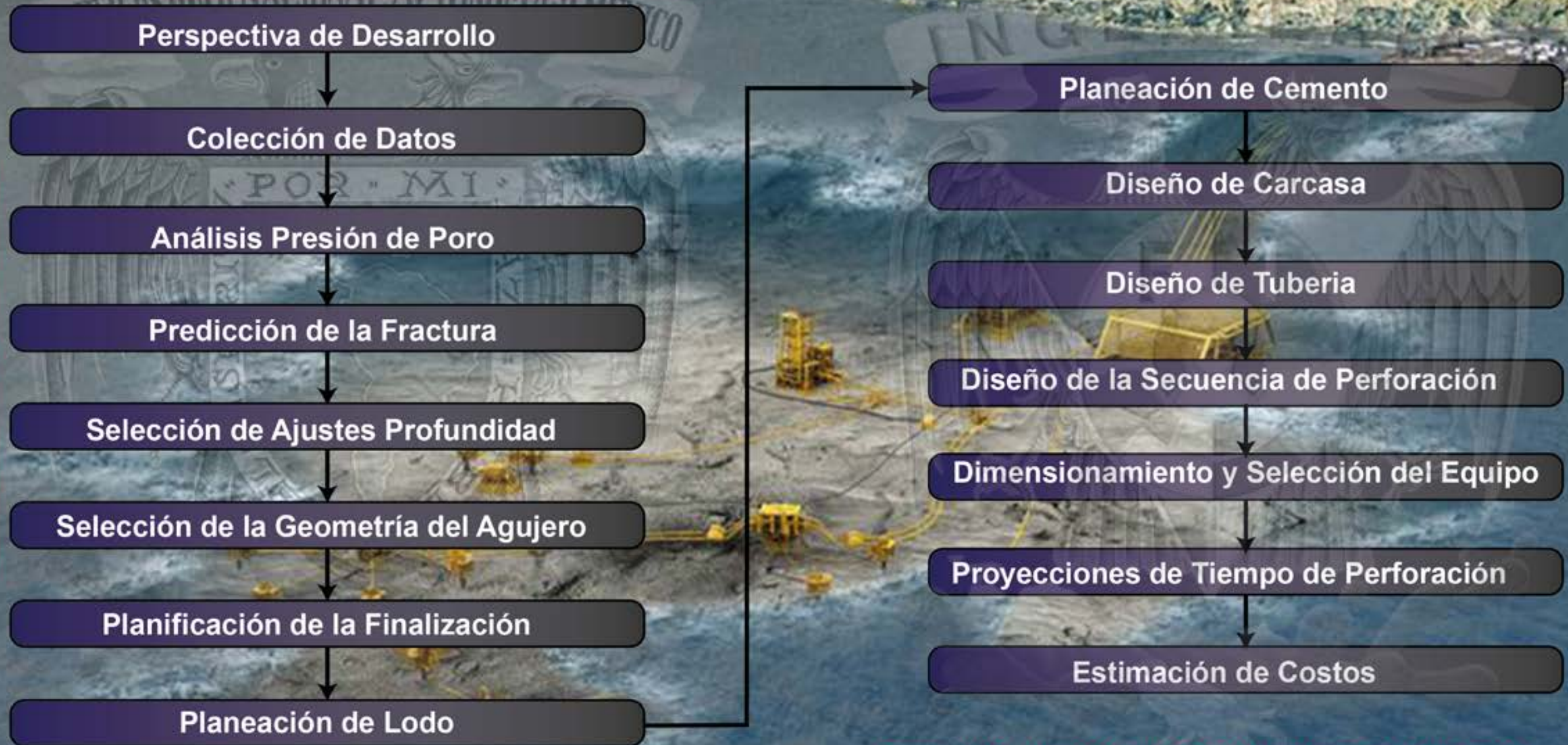
Imagen 4.38. Planeación y Ejecución de un Proyecto de Perforación. (Fuente: Tomada y modificada por Gerardo de Drilling and Well Activities)
