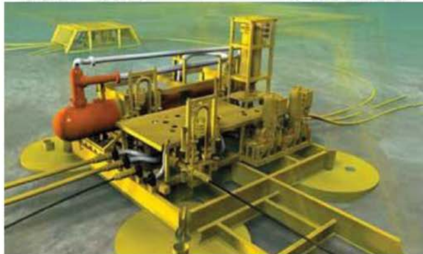
Imagen 5-97. Instalación de Separación, Impulsión e Inyección Submarina. Tordis. Noruega. (Fuente: Tomada equipos de procesamiento, Arker Solutions)
