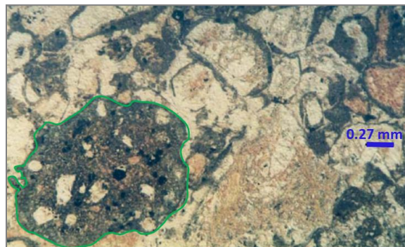
Figura.50 Facies de Diatrema de la kimberlita Black, mina Premier, Pretoria, muestra 1336. La roca se caracteriza por presentar estructuras pelletales que consisten en olivino alterado con pequeñas vetas grises, diópsido muy fino y glóbulos de kimberlita más grandes (delineado en verde), en una matriz reemplazada por diópsido gris fino. También están presentes xenolitos de roca encajonante y xenocristales (abajo a la derecha). Los componentes más grandes están sobre una matriz de serpentina. Tomada de Skinner y Marsh (2004).
