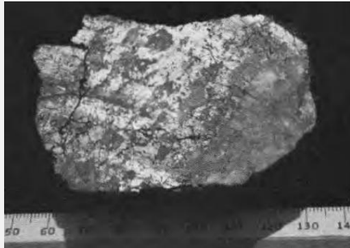
Figura.29 Muestra de mano del depósito Agua Titania, Pluma Hidalgo (México). El rutilo resalta en la muestra por su alta reflectancia. Tomada de Force (1991).
