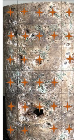
Figura 4.13: Método de conteo de cajas (malla No.1). Fotografía del núcleo de ejemplo número dos (Castro, 2019).
