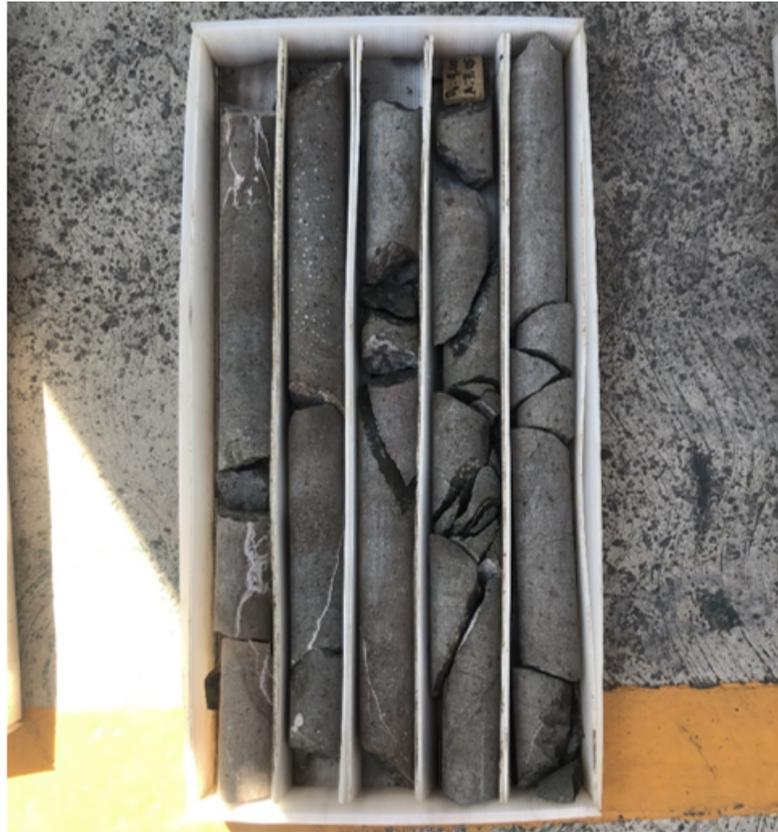
Figura 1.24: Ejemplo del análisis de núcleos. En la imagen se observa un tramo de aproximadamente 3 metros de núcleo de cuerpos andesíticos con fracturas naturales e inducidas, además de vetas.
