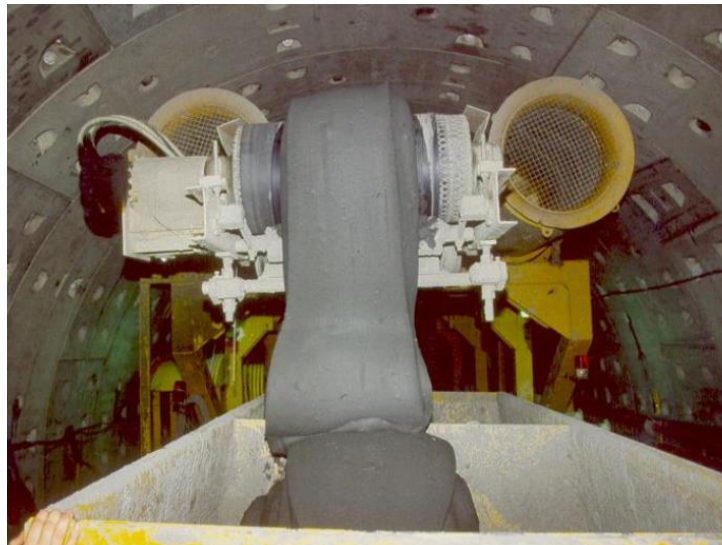
Figura 11 Consistencia del material acondicionado, fuente D. Peila
