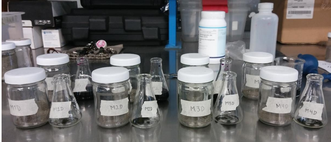
Figura 2. Soluciones de permanganato de potasio con sus duplicados y suelo contaminado.
