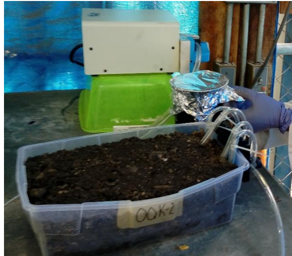
Figura 4. Sistema de tuberías que se usó en ambas charolas. Charola de \text{KMnO}_4 .
