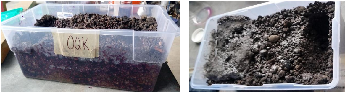
Figura 8. Charolas del experimento 2 después de agregar los oxidantes. A) charola donde se usó permanganato de potasio. B) charola donde se usó peróxido de hidrógeno.
