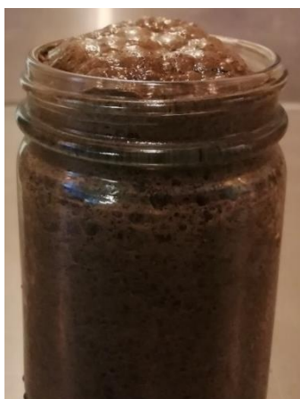
Figura 7. Reacción del \text{H}_2\text{O}_2 con el suelo contaminado.
