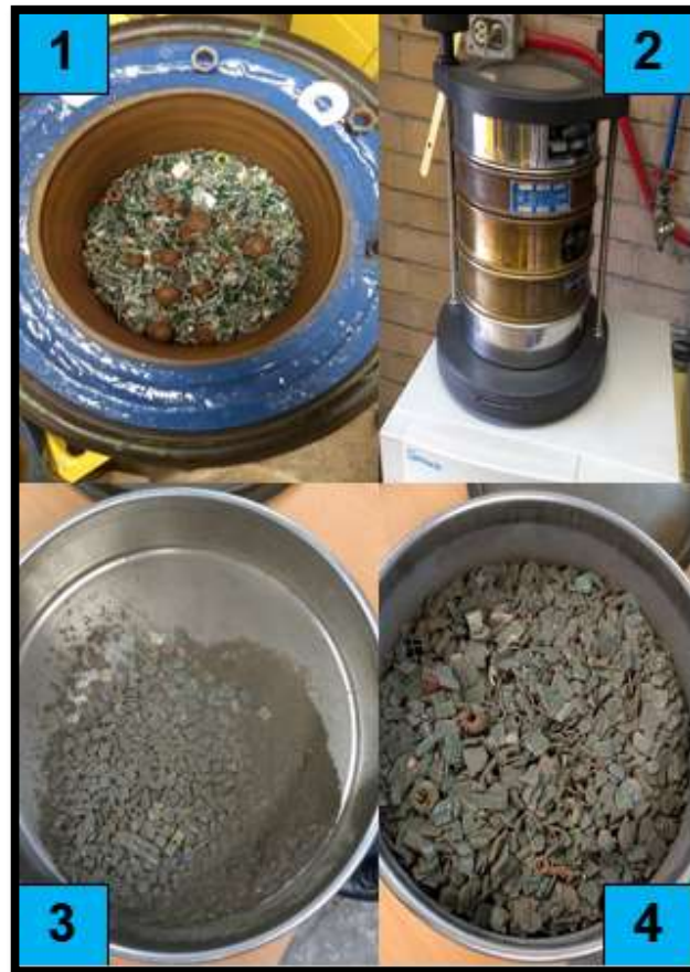
Figura 5. Proceso de reducción de tamaño. (1) El material es introducido al molino de bolas; (2) Se tamiza el material; (3) El material que queda en la malla 40 es separado; (4) El material restante se reintroducirá en el molino, empezando este ciclo nuevamente.
