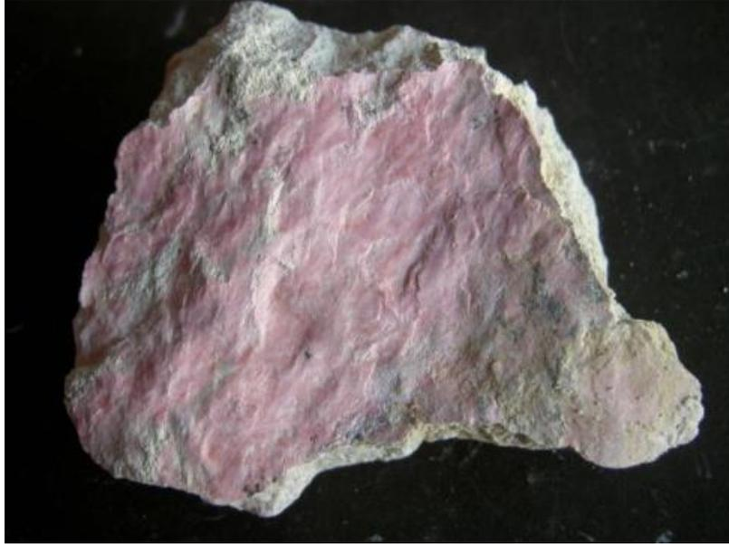
*Figura 2.5 Montmorillonita sódica*
