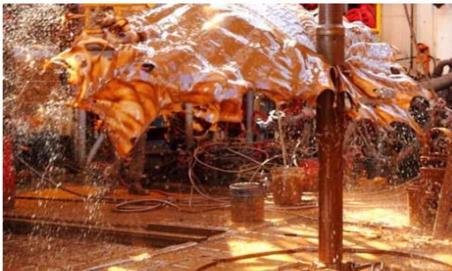
*Figura 3.1 Lodo de perforación*
