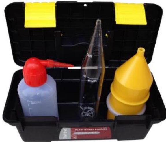
*Figura 3.9 Kit para la determinación de contenido de arena*
