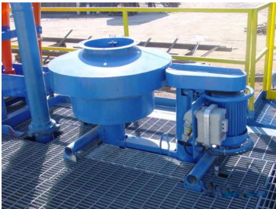
*Figura 3.18 Desgasificador*
