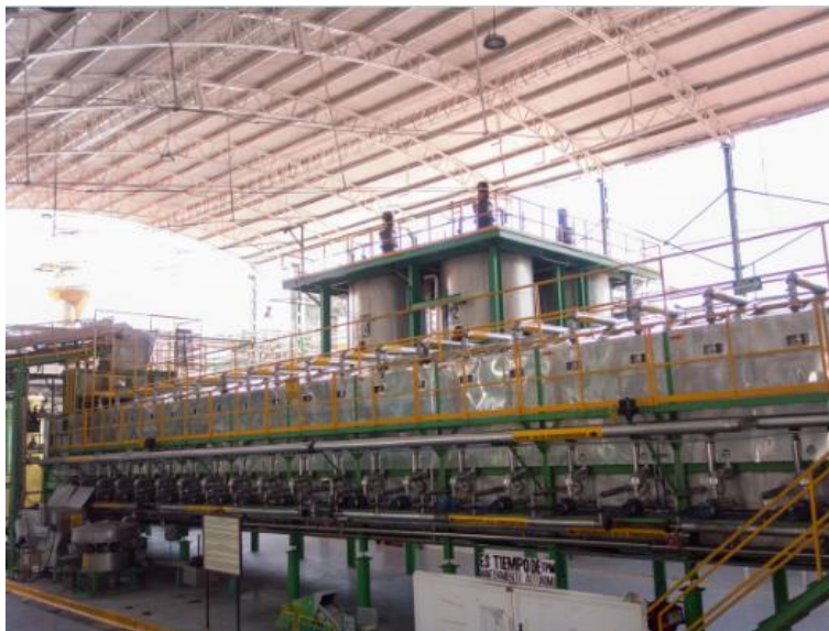
Figura 4.5 Difusor para extracción del jugo del agave
