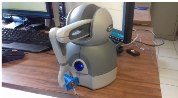
Figura 3.3: *Geomagic Touch* con el sensor de fuerza adaptado.
