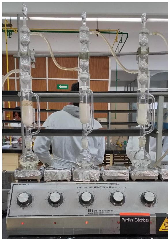
Figura 3.20 Extracción de grasas y aceites. Imagen propia
