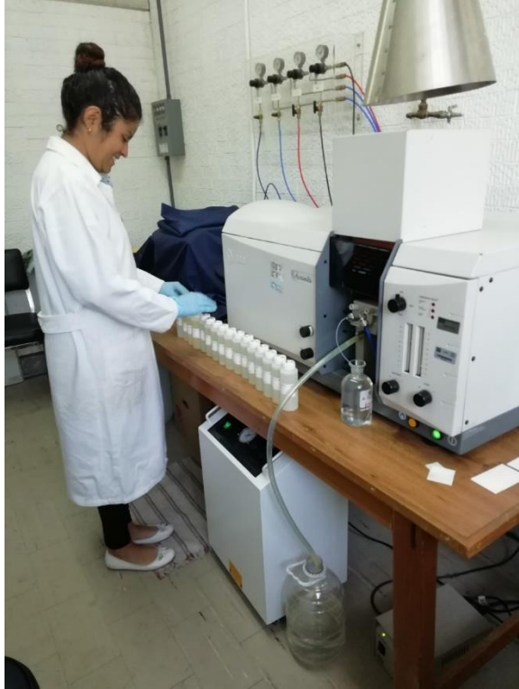
Figura 3.27 Toma de lecturas en equipo de absorción atómica. Imagen propia.
