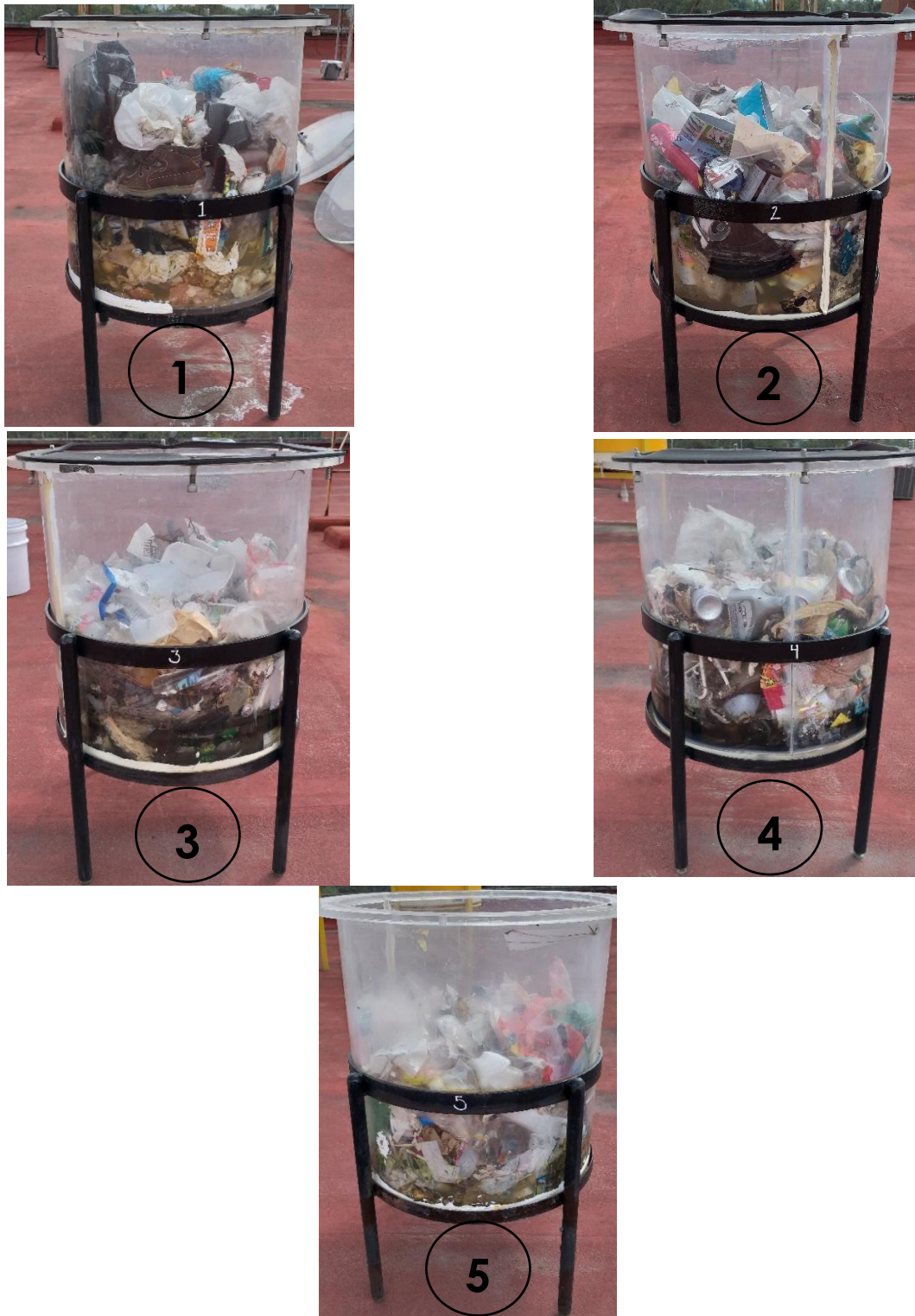
Figura 3.11 Lisímetros con inicio de generación de lixiviados, 16-oct-2018.
