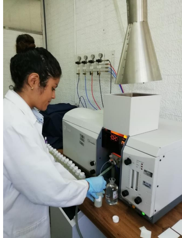
Figura 3.27 Toma de lecturas en equipo de absorción atómica. Imagen propia.
