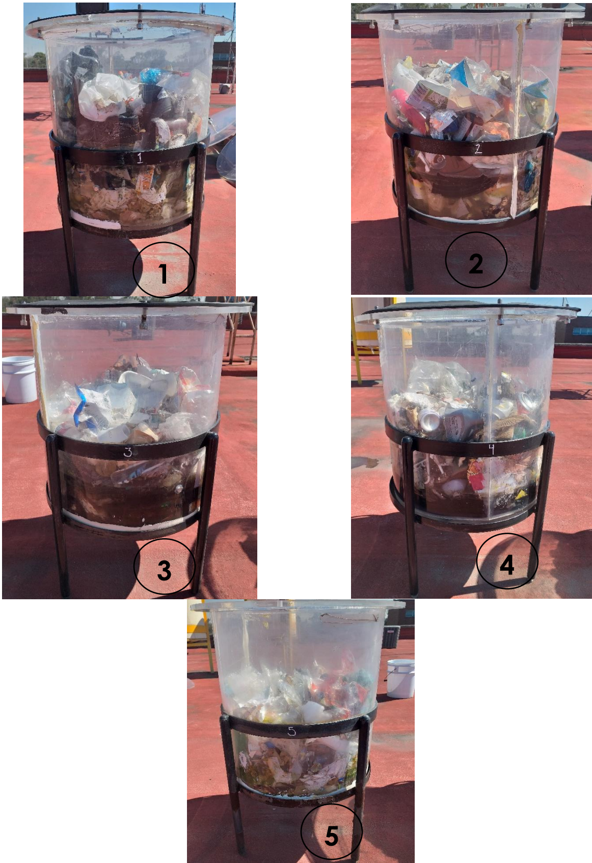
Figura 3.19 Lixiviado generado en el fondo de los lisímetros, 16-nov-2018.
