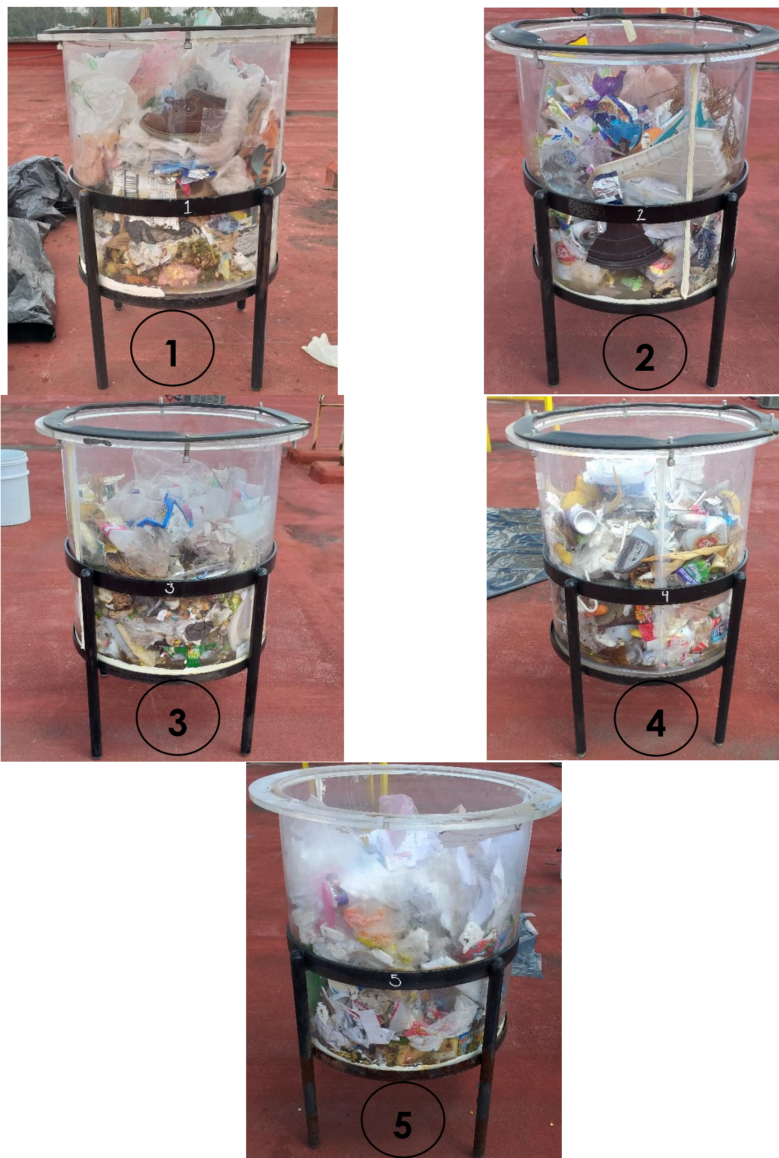
Figura 3.10 Lisímetros con residuos de acuerdo con las tablas 3.7 y 3.8, 7-sep-2018.
