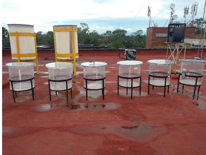
Figura 3.4 Lisímetros en azotea de posgrado de ingeniería. Imagen propia
