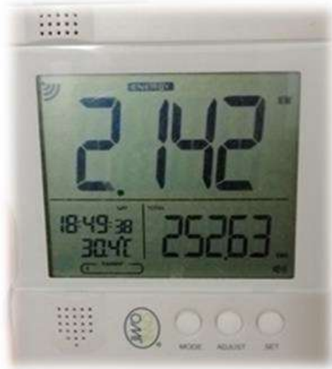
Ilustración 24. Monitor de energía, medición Horno Gourmet
