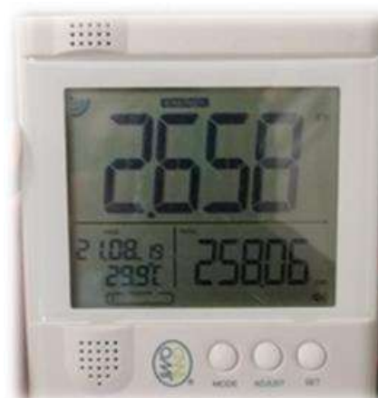
Ilustración 11. Monitor de energía de la medición de la campana de extracción de la parrilla
