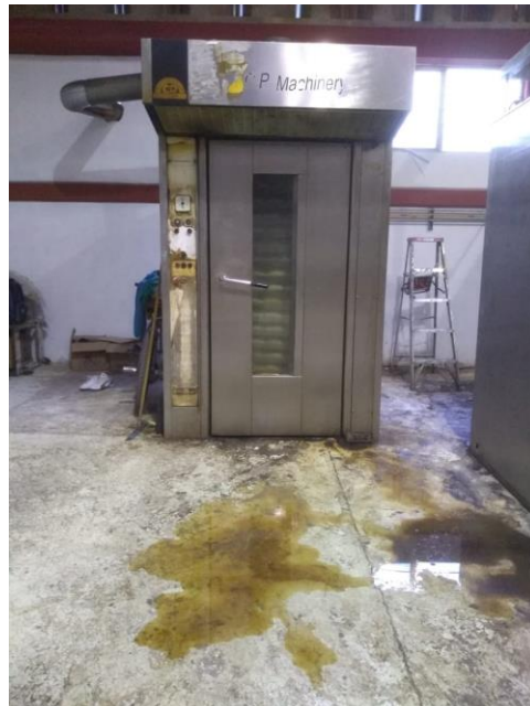
Figura 8. Restos del vapor condensado en la base del horno.
