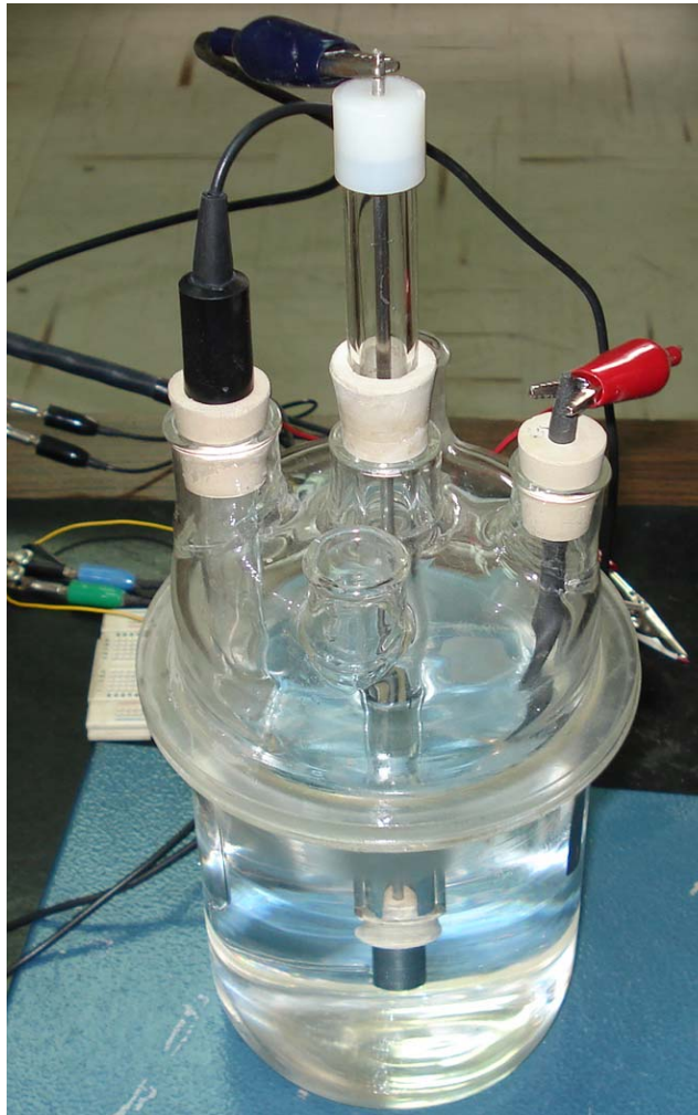
Figura 2.5 Celda de corrosión.
