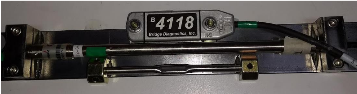
Figura 5.1.29 Arreglo de los sensores para el caso de estudio sobre la barra metálica tipo 02
