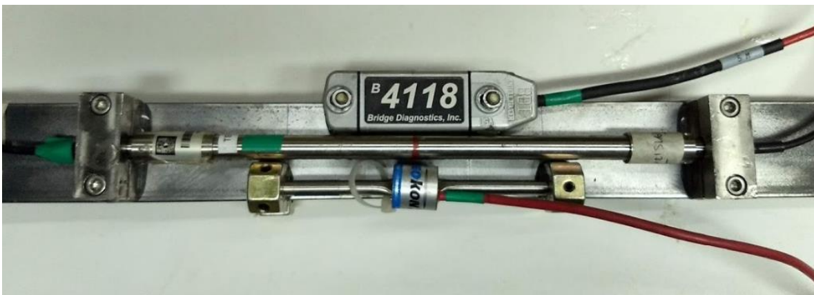
Figura 5.3.49 Instrumentación superior de la barra tipo 02, se aprecian las etiquetas verdes
