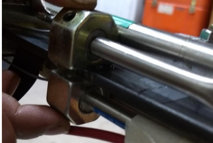
Figura 5.1.31 Fijación de las bases del SCV
