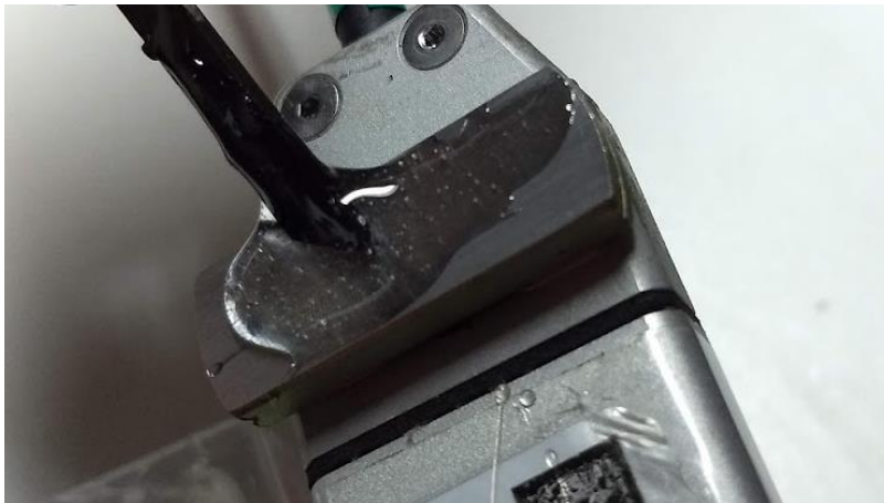
Figura 5.1.23 Distribución del pegamento sobre las bases
