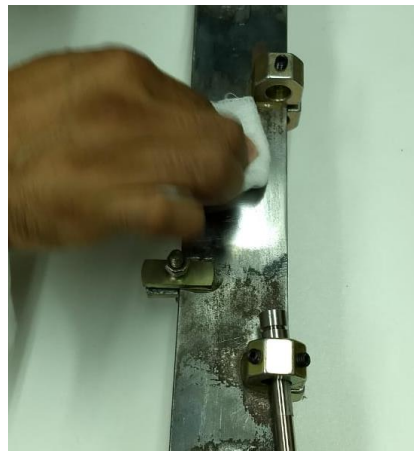
Figura 5.1.5 Limpieza de la superficie con una gasa
