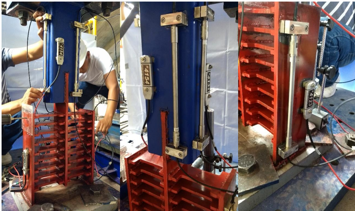
Figura 5.5.17 Instalación de los instrumentos de medición sobre el disipador de energía.
