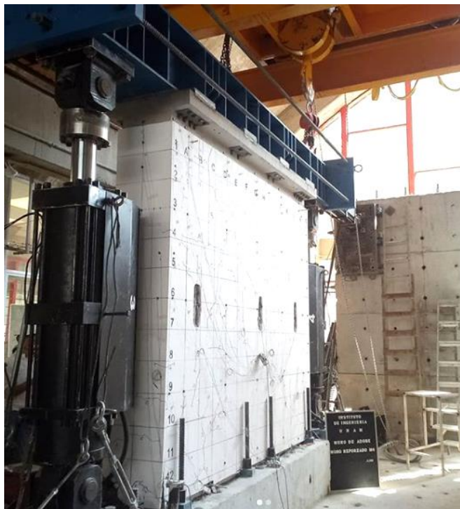
Figura 5.4.2 Espécimen 4 montado en el marco de carga y listo para iniciar la prueba
