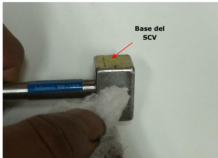
Figura 5.1.28 Limpieza de las bases del SCV
