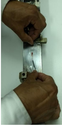
Figura 5.1.8 Colocación del DE sobre la superficie
