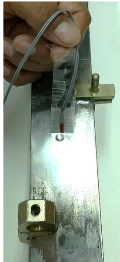
Figura 5.1.11 Aplicación del pegamento
