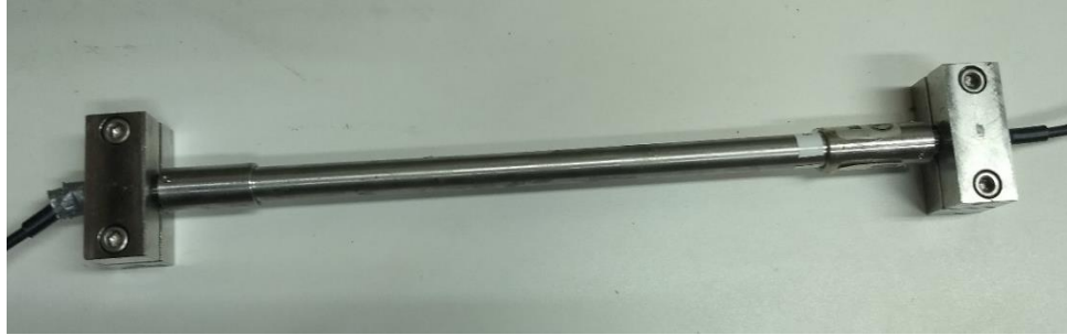
Figura 3.4 Sensor de fibra óptica quasi-distribuido
