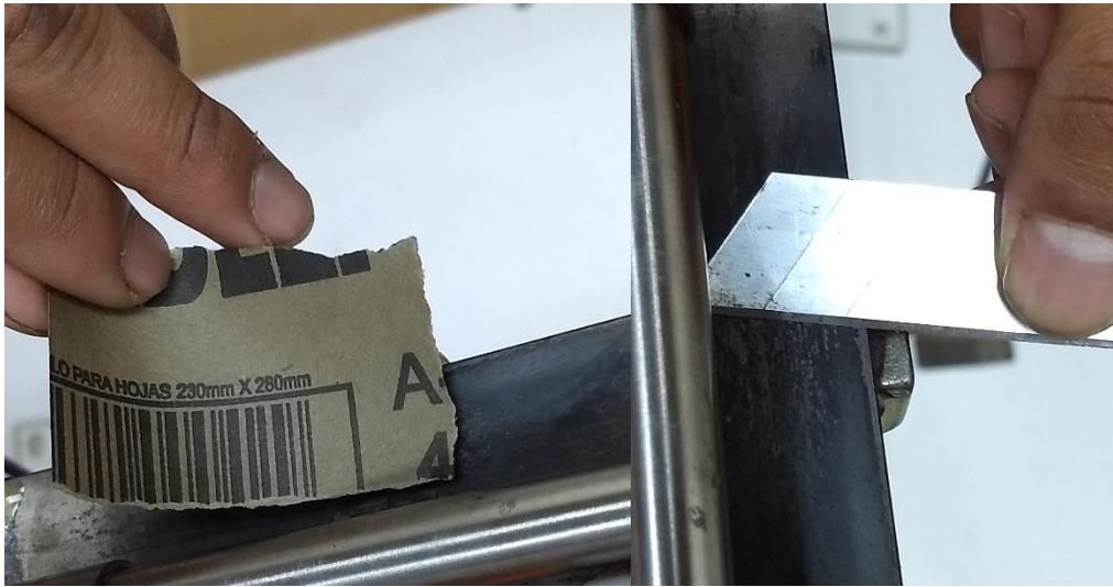
Figura 5.1.25 Remoción de las asperezas sobre la superficie
