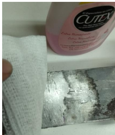
Figura 5.1.33 Limpieza de la superficie con acetona
