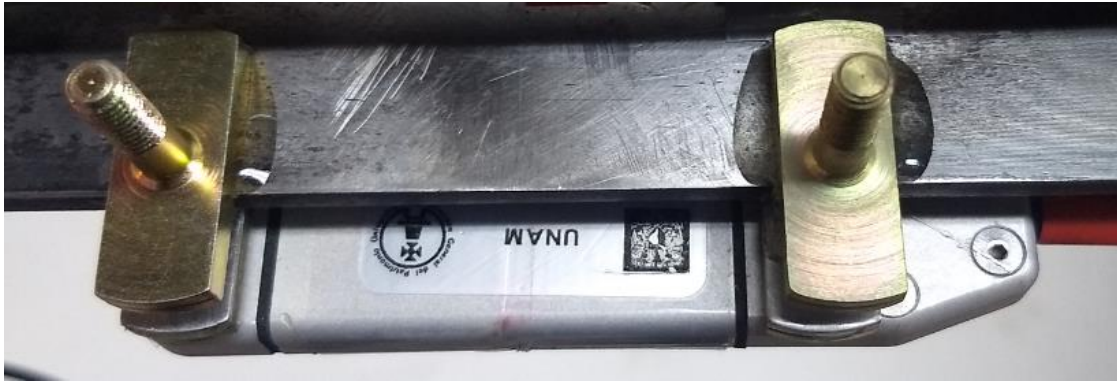
Figura 5.1.24 En la parte superior se puede apreciar las bases pegadas en la superficie (sin el BDI) y en la cara contraria se puede ver el BDI completamente instalado.
