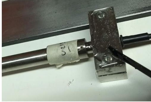
Figura 5.1.36 Distribución del pegamento sobre una base del SFO
