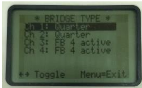
Figura 5.2.10 Configuración de los tipos de puentes a usar
