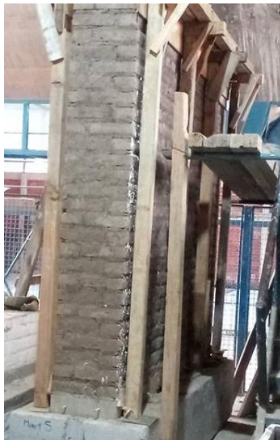
Figura 5.4.1 Muro de adobe aún sin refuerzo y sin recubrimiento – Espécimen 4
