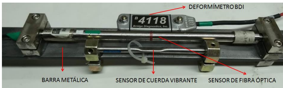
Figura 5.3.42 Barra metálica instrumentada
