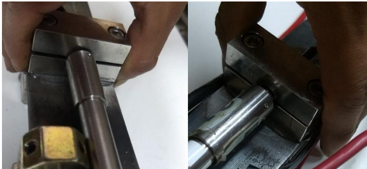
Figura 5.1.37 Fijación de las bases del SFO
