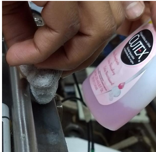
Figura 5.1.26 Limpieza con acetona
