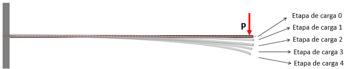
Figura 5.3.6 Esquema de la barra metálica deformada en las diferentes etapas de carga
