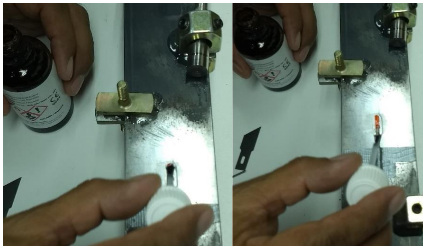
Figura 5.1.19 Aplicación de la resina protectora
