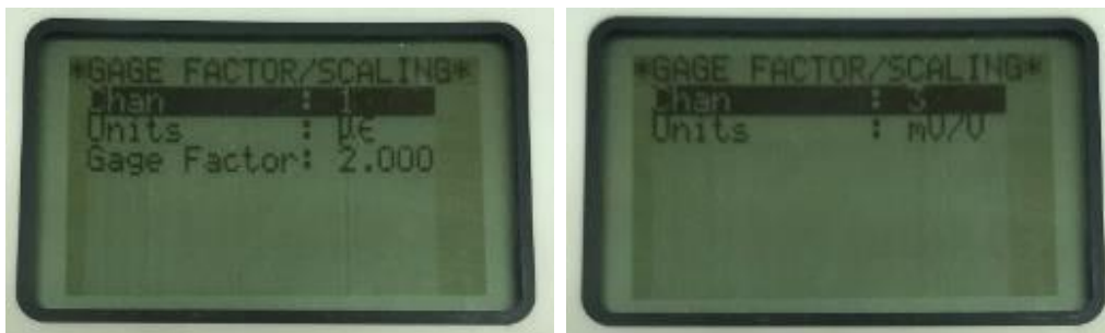
Figura 5.2.11 Configuración de los factores de galga y unidades de captura
