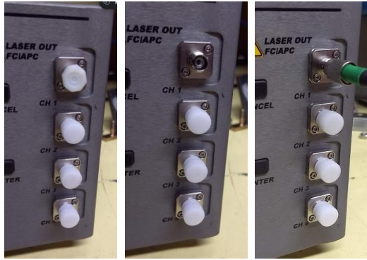
Figura 5.2.45 Conexión del SFO al si425
