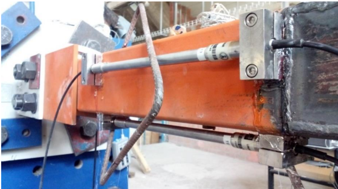
Figura 5.5.10 Colocación de sensores de fibra óptica
