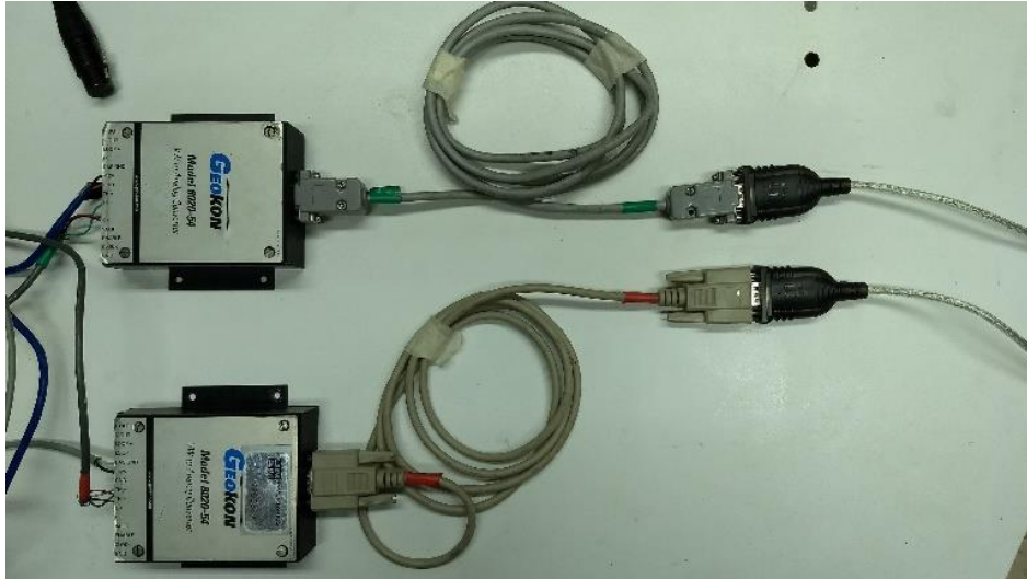
Figura 5.2.26 Conexión del convertidor analógico con la fuente de poder
