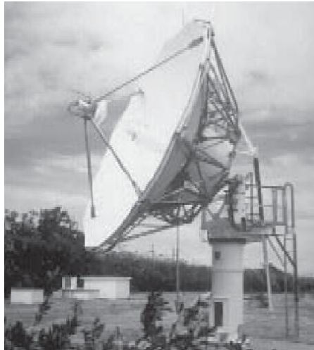
Figura 2.20 Antena Cassegrain, tomada de [Neri, 2003].
