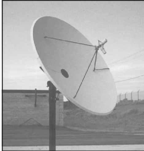
Figura 2.18 Antena con alimentación frontal [Neri, 2003].
