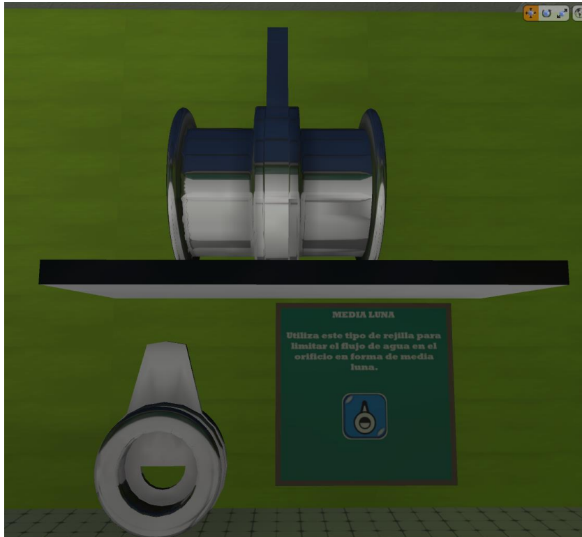
Figura 3.33 Muestra de la placa de orificio segmentada junto con su descripción.
