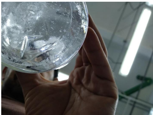
Figura 4.19. Precipitación de las sales de la salmuera MIG-S en el fluido MIG-S3. Fuente: Elaboración propia.
