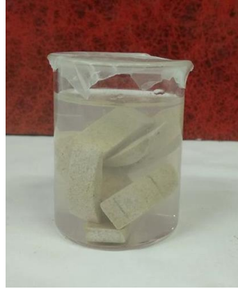
Figura 4. 20. Añejamiento de láminas de roca MIG-R en salmuera estabilizada MIG-S. Fuente: USIP.
