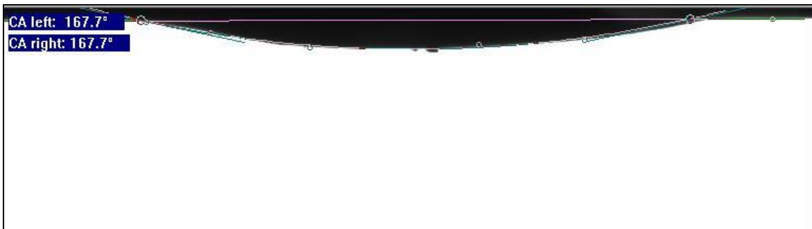
Figura A3. 16. Ángulo de contacto de aceite MIG-A en agua de la CAB MIG-S y roca M296 añejada en nanofluido ZnO/SiO 2 .
