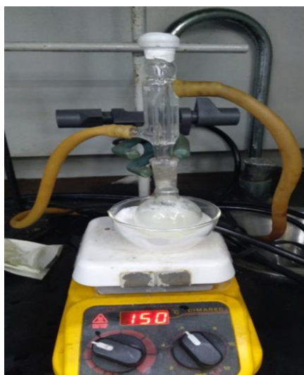
Figura 4. 11. Desagregación de las NPs de SiO 2 mediante un sistema a reflujo. Fuente: Elaboración propia.
