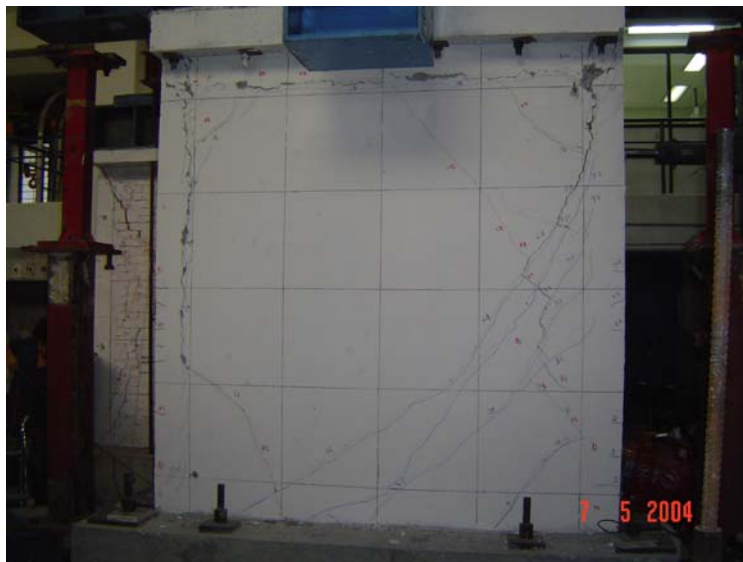
Figura 3.10. Estado final del muro MCC0M
