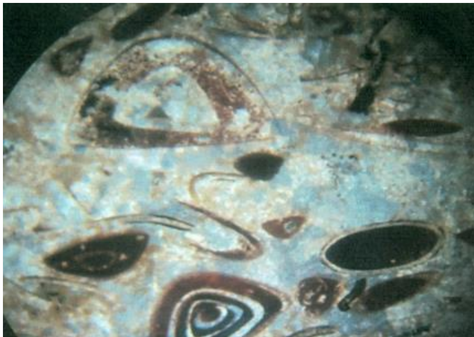
Figura. 14. Microfotografía (X7). Caliza fosilífera, presenta cemento de esparita, con cortes de Salterella sp., Hyolithes sp., según la clasificación de Dunham, 1962, corresponde a grainstone, Folk, 1962, bioesparita (Tomado de Cuen, 2012).
