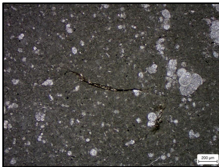
Fotomicrografía 51 Sección delgada MTZ-P8, tomada con objetivo 5x y Lp. Sedimentos no consolidados en tiempos de sedimentación (penecontemporaneos), posiblemente relleno de materia orgánica.
