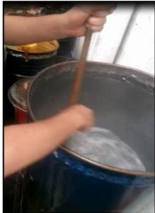
Calentar 50 kg de parafina en tanques cilíndricos calentados por parrillas de gas natural por 2 hrs y después agregar 5 kg de colorante
