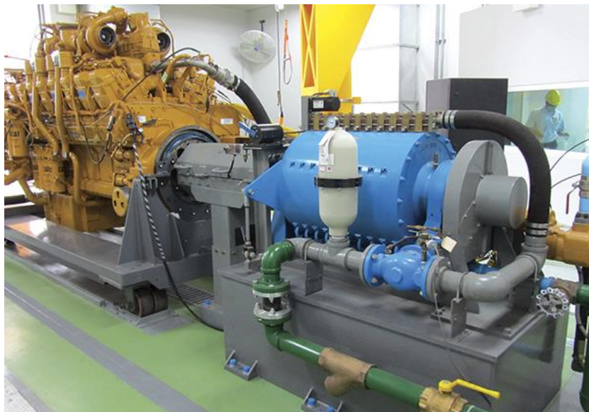
Figura 1.4 Dinamómetro de banco manufacturado por POWER TEST [4] .
