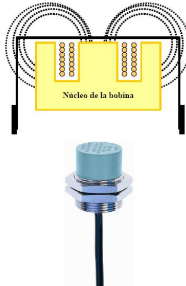
Figura 2.3. Sensor inductivo de proximidad no enrasable [3].
