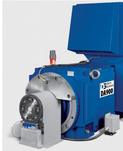
Figura 1.24. Dinamómetro de banco de AC manufacturado por Taylor Dynamometer [24].
