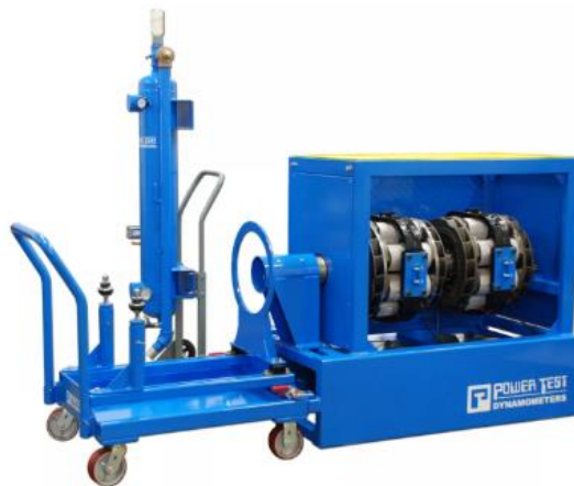
Figura 1.26. Dinamómetro de banco de corrientes de Eddy manufacturado por Power Test [26].
