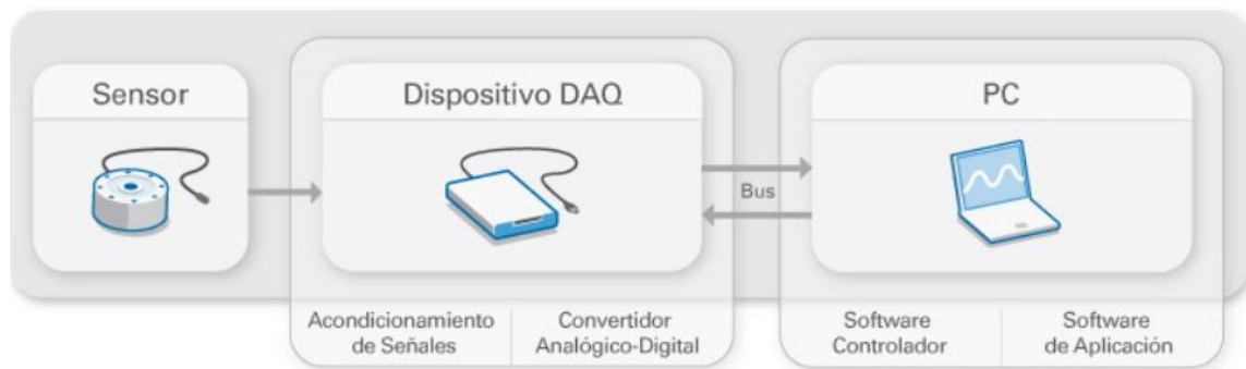
Figura 2.7. Partes de un sistema DAQ [7].
