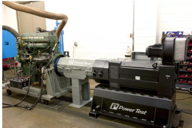
Figura 1.27 Dinamómetro de banco de CA manufacturado por Power Test [27].
