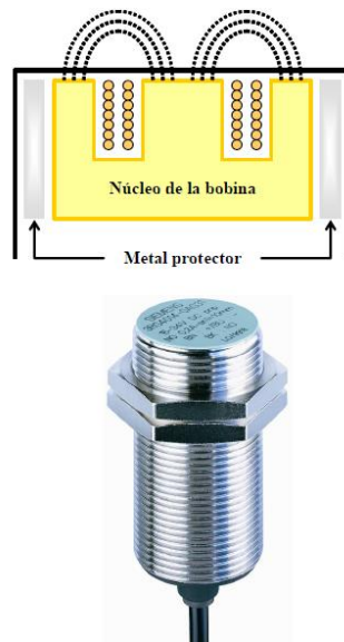
Figura 2.2. Sensor inductivo de proximidad enrasable [2].
