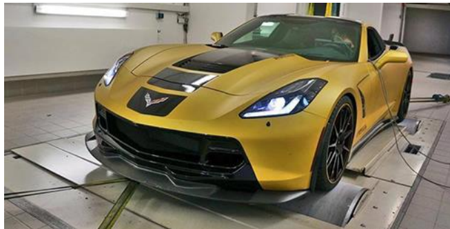
Figura 1.2 Dinamómetro de chasis manufacturado por SuperFlow [2].
