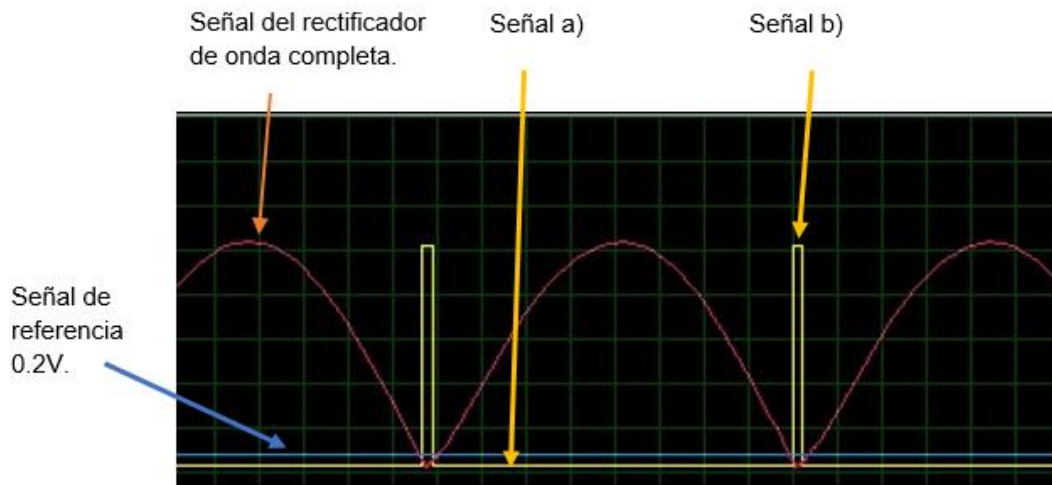
Figura 3.11. Formas de onda que se generan en el circuito inversor detector de cruce por cero.
