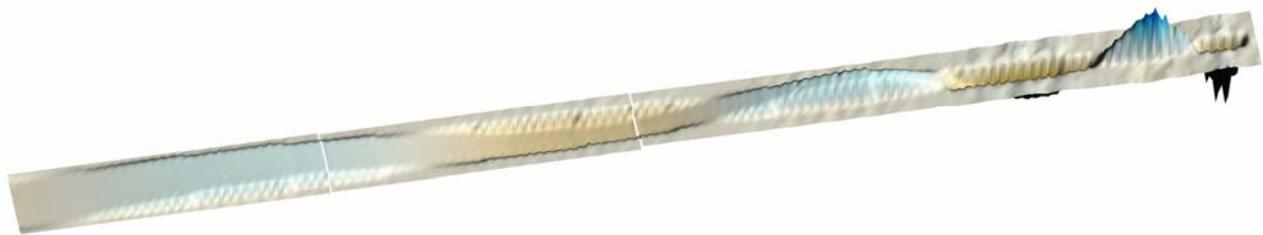
**Figura 3.4. Superficie libre del agua en el momento de la mínima sobrelevación**
