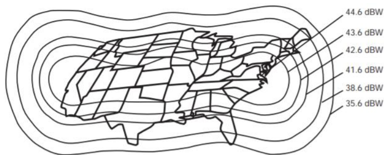
Figura 22. Siete Patrones de radiación de antena de satélites (huellas). 136
