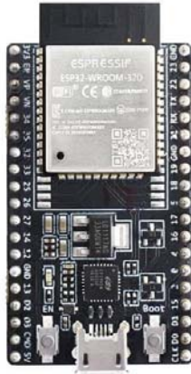
Figura 96. Tarjeta ESP32 con módulo Wifi 22 .
