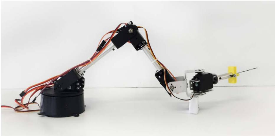
Figura 80. Dispositivo Esclavo, robot manipulador serial de 5GDL.
