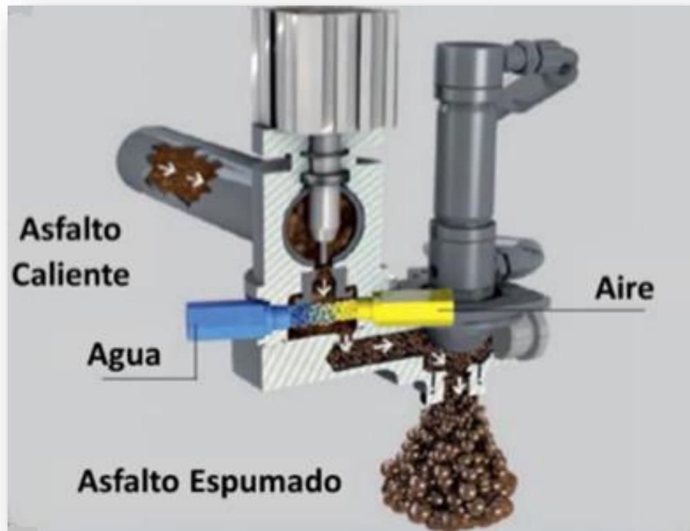
Ilustración 10 Teniendo en cuenta la presión y la temperatura, en las cámaras de expansión se produce asfalto espumado de excelente calidad.
