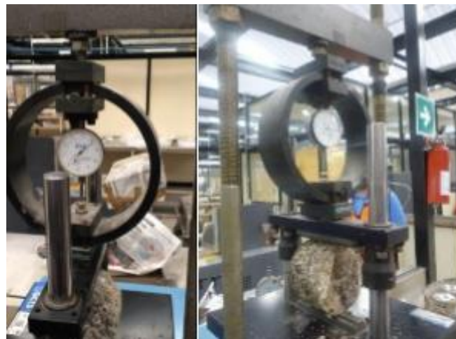
Ilustración 28 Equipo Indirect Tensile Strength que se utiliza para conocer el esfuerzo máximo admisible antes de producirse una grieta o falla en los asfaltos espumados.
