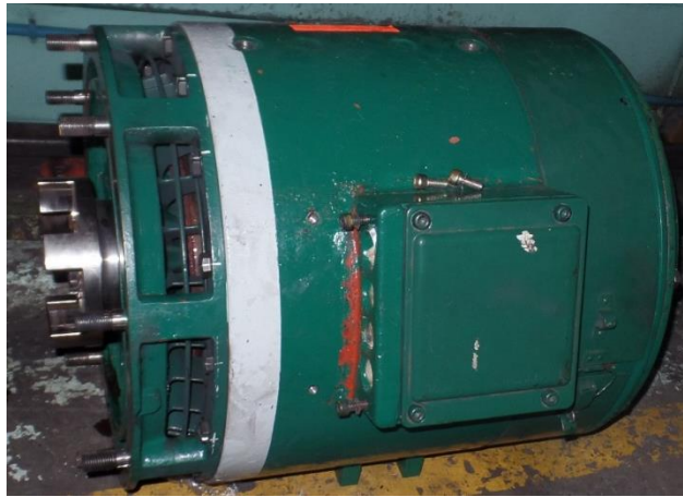
Figura 11 Motor DC rehabilitado.
