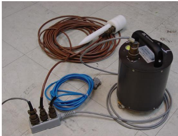
Figura 2.4. Sismómetro triaxial Guralp 6TD
