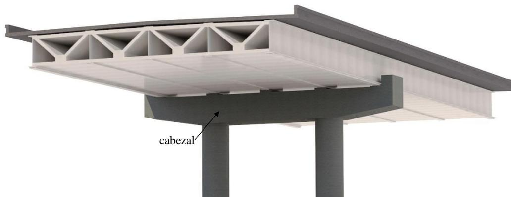
*Figura 27. Esquema del cabezal del puente*
