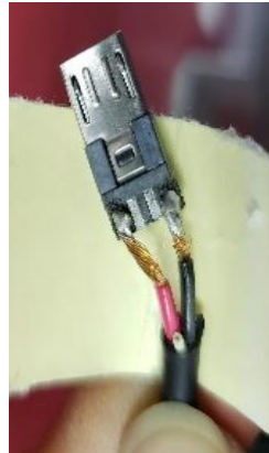
Ilustración 34. Unión por soldadura de cable con conector V8
