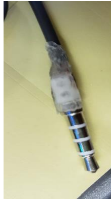
Ilustración 29. Colación de silicón entre conector y cable
