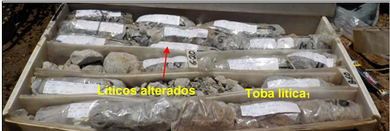
Fotografía 4.44. Testigos recuperados de los 0.00 a los 9.80 m, considerados como la zona alterada de la Toba lítica 1 .
