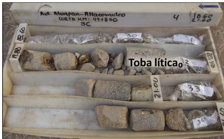
Fotografía 4.43 Testigos recuperados del sondeo 4 (de los 18.60m a los 21.60m) donde se muestran los bloques de la Toba lítica 0 .
