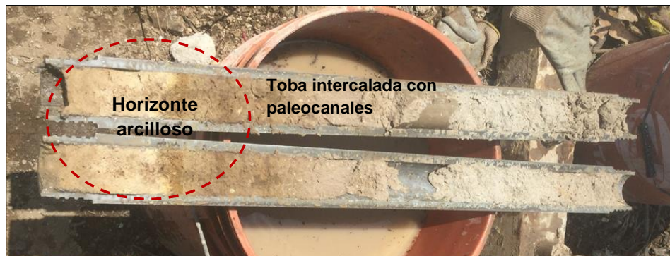
Fotografía 4.42. Testigo recuperado de los 14.40 a los 15.00 m, donde se identifica la subunidad Toba intercalada con paleocanales y el horizonte arcilloso.
