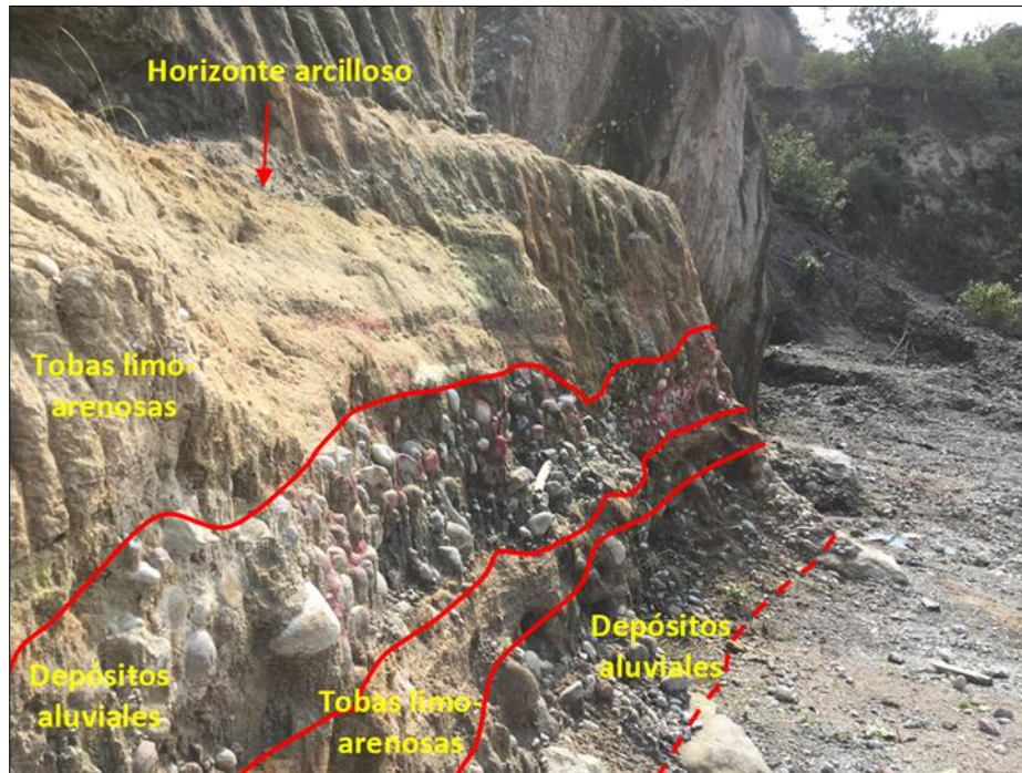
Fotografía 4.34. Contactos erosivos en la Toba intercalada con paleocanales.
