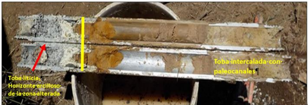
Fotografía 4.45 Testigo recuperado del sondeo 5, donde se identifica el contacto entre Toba intercalada con paleocanales y el horizonte arcilloso de la zona alterada de la Toba lítica 1 .
