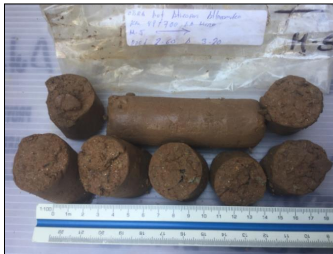
Fotografía 4.47. Muestra recuperada de los 2.60 a los 3.20 m, considerada como la zona limosa alterada.
