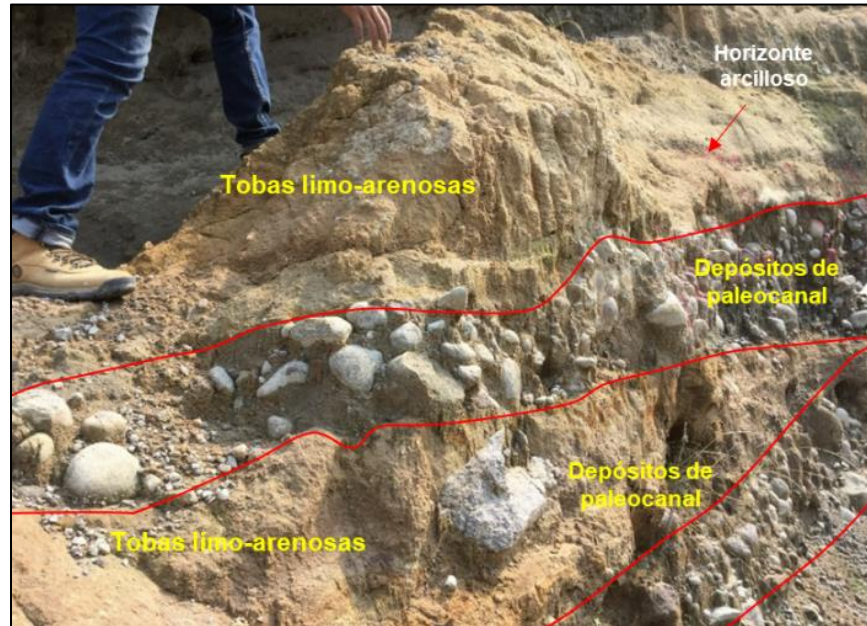
Fotografía 4.16. Tobas intercaladas con paleocanales. En rojo se distingue el contacto erosivo de la subunidad y horizontes arcillosos.
