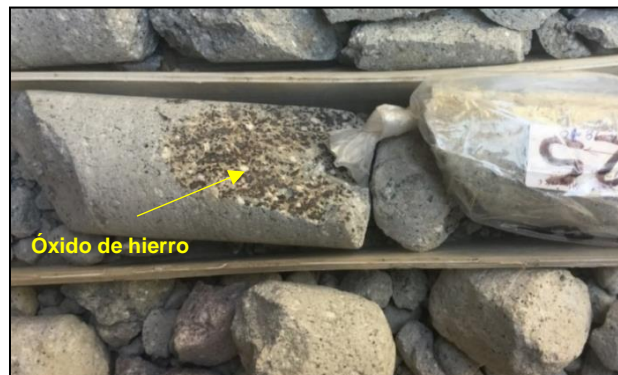
Fotografía 4.25. Testigos recuperados del sondeo km 49+700 (de los 15.90 a 18.00 m), donde se observa líticos alterados y con presencia de óxidos.
