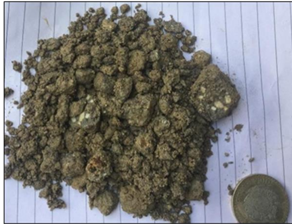
Fotografía 4.12. Horizonte alterado compuesto por matriz limosa y líticos altamente alterados. Sondeo 49+800 (de los 3.80 a 4.80).
