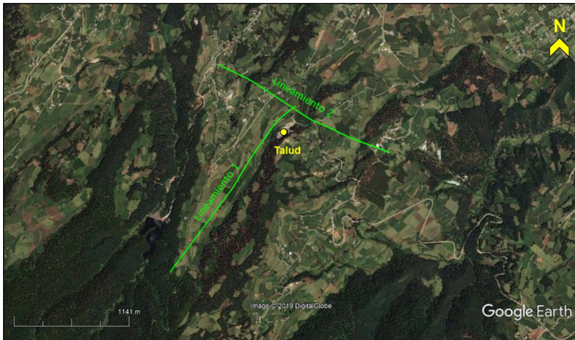
Figura 4.30. En verde se identifica los lineamientos 1 y 2. El primero se asocia a una fractura con dirección NE-SW, reportado en la carta geológica (INEGI E14A28), escala 1:50,000, el cual se asemeja a la dirección que presenta la zona de fallas La Catedral. El segundo presenta una dirección NW-SE identificado fotogeológicamente.
