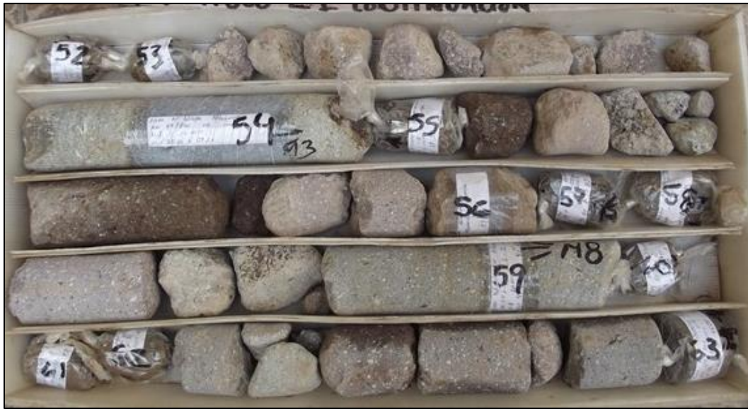
Fotografía 4.46. Testigos recuperados de los 38.80m a los 44.00 m, identificados como la Toba lítica 0 .
