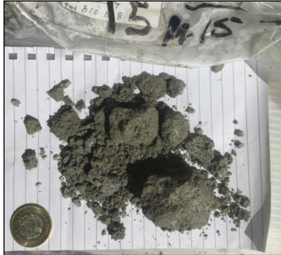
Fotografía 4.40. Muestra recuperada del sondeo 3 (de los 8.20 a 8.80 m), reinterpretada como la zona limosa.
