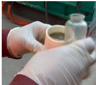
Ilustración 162 Filtración de lodos bentoníticos 7
