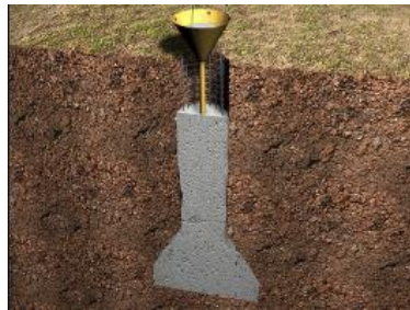
Ilustración 10 Colocación de concreto fresco en una pila. 16
