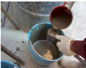
Ilustración 159 Aplicación de lodo bentonítico en recipiente calibrado. 7
