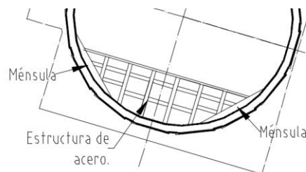
Ilustración 131 Composición de estructura de acero de la plataforma. 47
