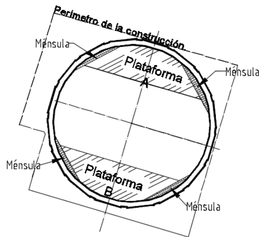
Ilustración 130 Ubicación de plataformas. 47
