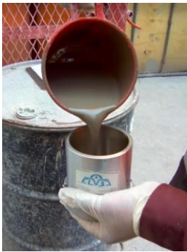
Ilustración 164 Vertido del lodo bentonítico. 7
