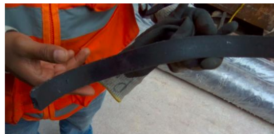
Ilustración 115 Junta Hidroflex en el almacén. 7
