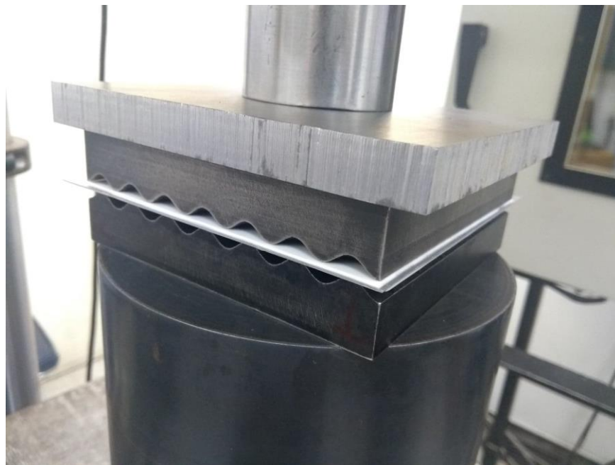
Figura 2. 4. Prueba de carga en el proceso RCS (interfaz entre el molde y la máquina de ensayos universal).
