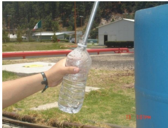
Ilustración 13. Se muestra el momento a la hora de obtener las muestras del condensado para la obtención del gasto másico.
