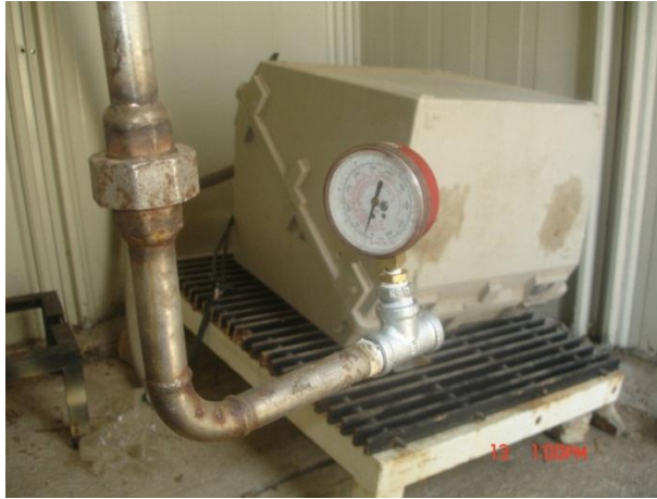
Ilustración 10. Se muestra el montaje final del manómetro antes de la medición de la presión.
