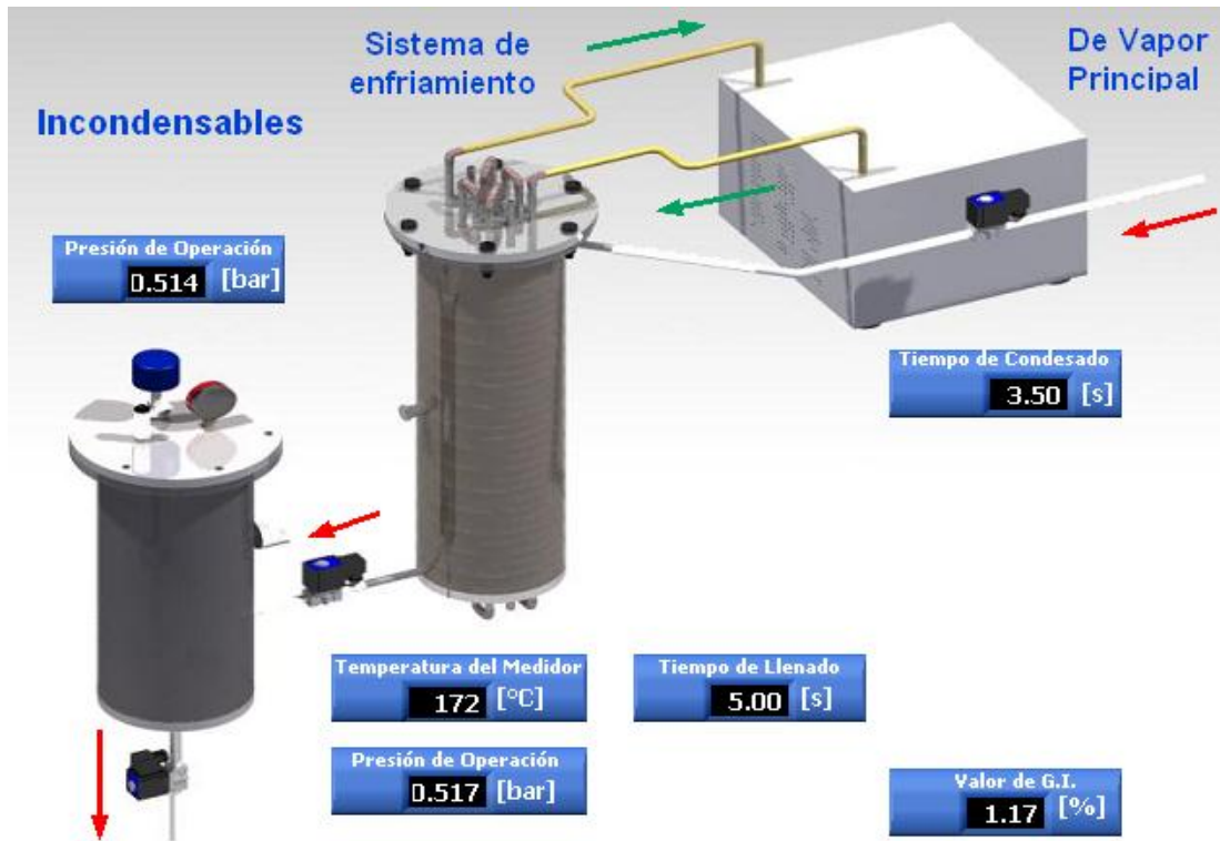
Ilustración 39. Esquema general del equipo con indicadores numéricos.
