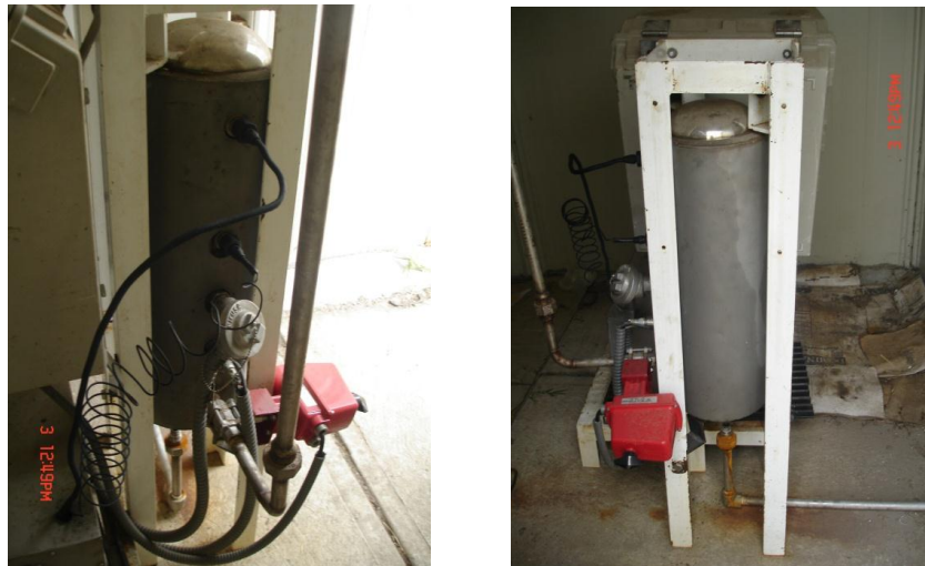
Ilustración 1. Fotografías del anterior prototipo de medidor de G.I. donde la teoría de gases ideales era utilizada.
