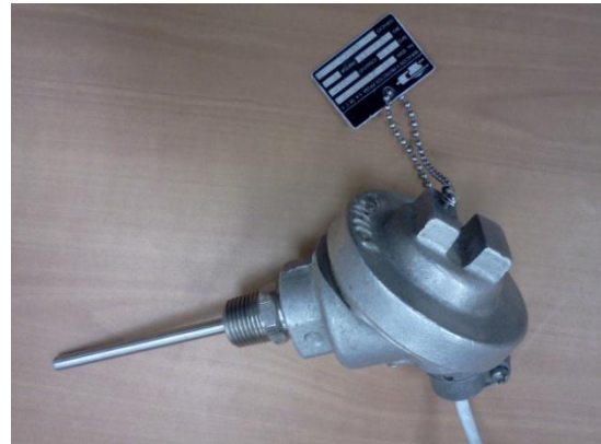
Ilustración 23. Ubicación del RTD en el medidor.
