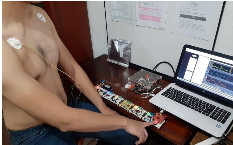
Figura 99. Sujeto de prueba conectado sistema de registro de variables cardiacas.
