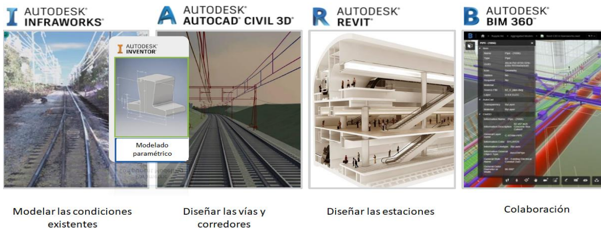
Figura IV-17 Proceso propuesto por Autodesk para proyectos ferroviarios con BIM 71 .
