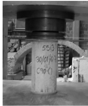
Fig.4.6 Probetas de 15 x 30 cm. ensayadas a compresión.
