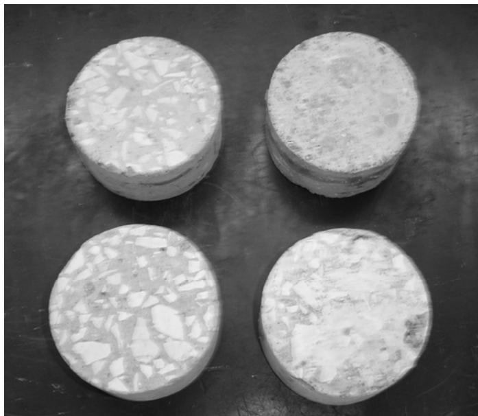
Fig. 4.1 Probetas de concreto cortadas.
