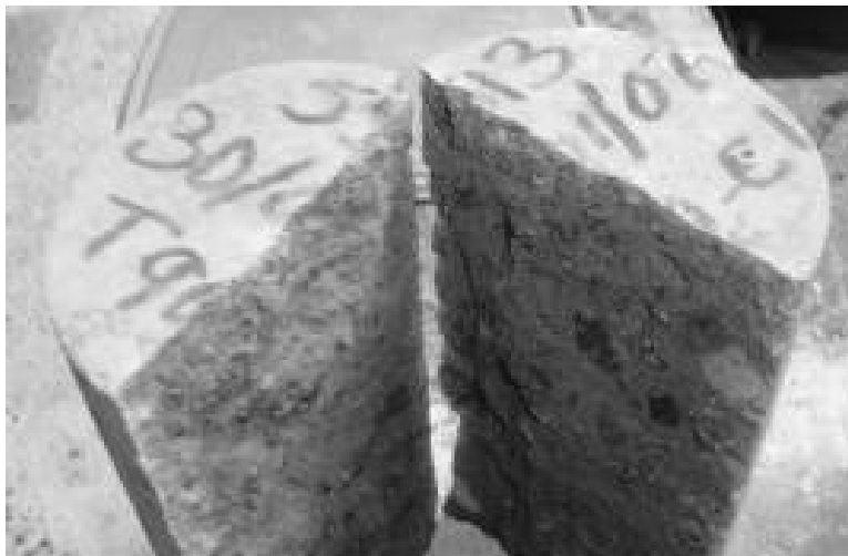
Fig. 4.9 Forma de rotura de las probetas ensayadas a tensión indirecta.
