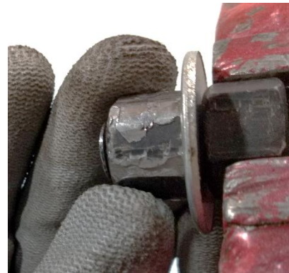
Figura 62 Colocación de tuerca con deformación en su geometría para pruebas 4 a 6.
