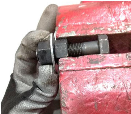
Figura 59 Colocación de tuerca sin deformación para las pruebas 1 a 3.
