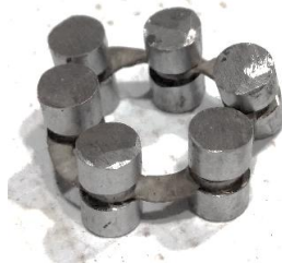
Figura 48 Convertidor de llave estándar a llave ajustable para elementos hexagonales deformados.
