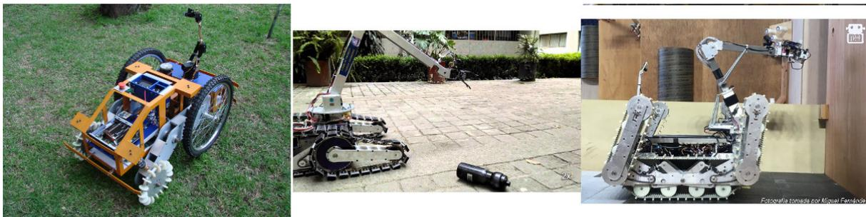
Figura 2.1 Fotografías que muestran el proceso iterativo del robot FinDER, de izquierda a derecha el FinDER v1, el FinDER v2 y el FinDER v3
