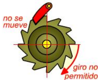
FIGURA 55. Sistema de trinquete (33)
