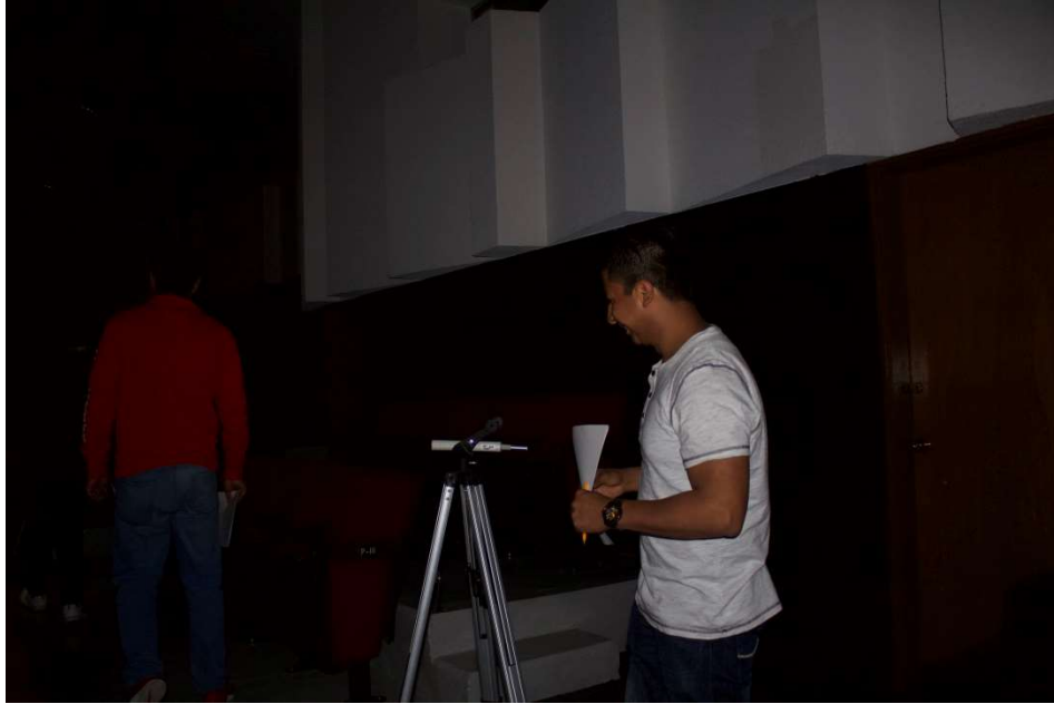
Figura 40. Medición Aislamiento Bruto (STC) I, Sala Silvestre Revueltas
