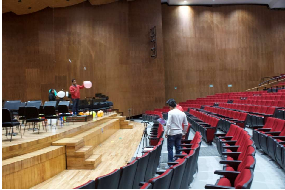
Figura 51. Medición Punto 2 del tiempo de reverberación, Sala Silvestre Revueltas
