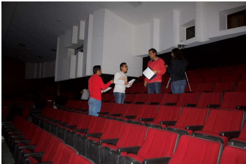
Figura 41. Medición Aislamiento Bruto (STC) II, Sala Silvestre Revueltas
