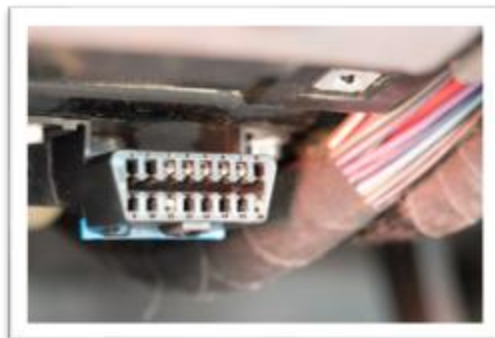
Figura 2.31, que muestra el conector DLC OBD II que por norma todo vehículo tiene incorporado a partir del año 1996. Este conector siempre se halla en el interior del vehículo, a muy corta distancia del asiento del conductor
