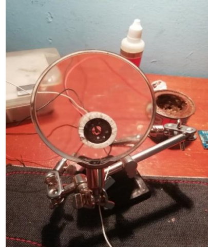
Figura 2.25. Donde se aprecia el montaje realizado Del sensor MQ-3 y MQ-7 en el tubo de PVC de ½”.
