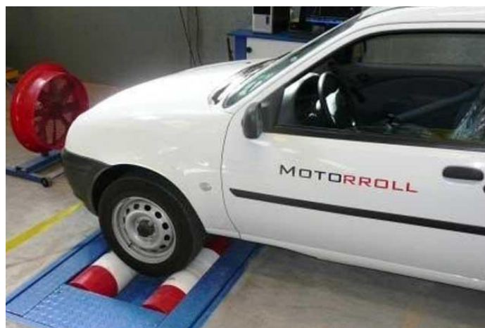
Figura (1,2) se muestra a un vehículo particular realizar la prueba dinámica a régimen constante en un equipo BAR-90. Imagen tomada de internet
