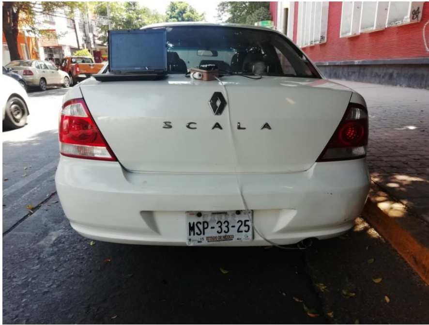
Figura 4.2. Muestra el desarrollo de un análisis de gas de tipo estático en un vehículo Renault Scala modelo 2011 con 127,012km en servicio, que recién aprobó la verificación ambiental.
