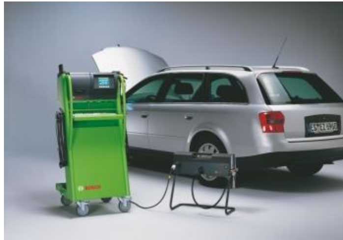
Figura (1.1) Se muestra un analizador de gases del fabricante alemán Bosch® realizando una prueba de emisiones estática. Imagen tomada de internet
