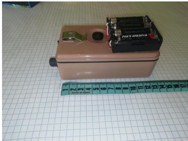
Figura 2.11. Vista de perfil del compresor y sus dimensiones aproximadas. En esta imagen se puede apreciar el montaje externo de las baterías tipo AA
