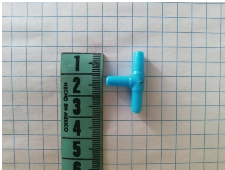
Figura 2.6, Que muestra las características básicas y dimensiones de la TEE empleada
