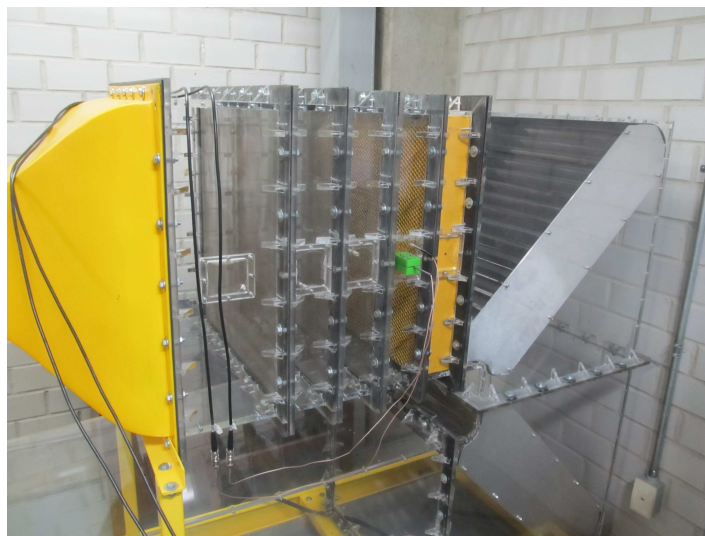
Figura 3.20: Sistema HWA en la sección de asentamiento, tomando datos tras el panel
