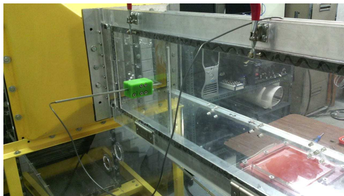
Figura 3.17: Sistema HWA acoplado al túnel en su sección de pruebas registrando datos de velocidad.
