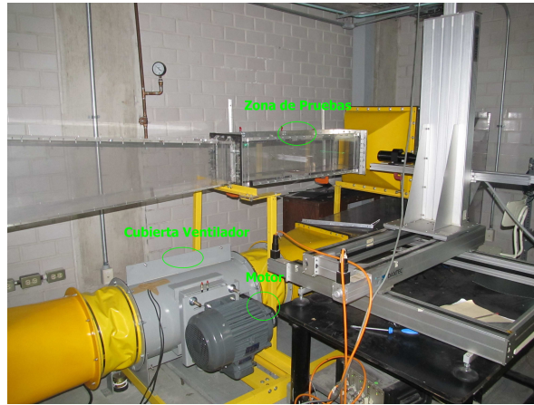
Figura 3.21: Lugares en los cuales se registró valores de vibración: en el motor, en la carcasa del ventilador y la zona de pruebas del túnel.
