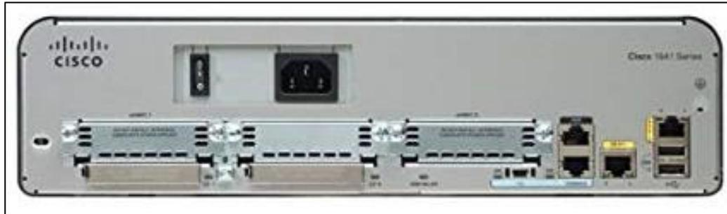
Figura 2.1 Parte posterior de un router Cisco, común en oficinas branch.<sup>3</sup>
