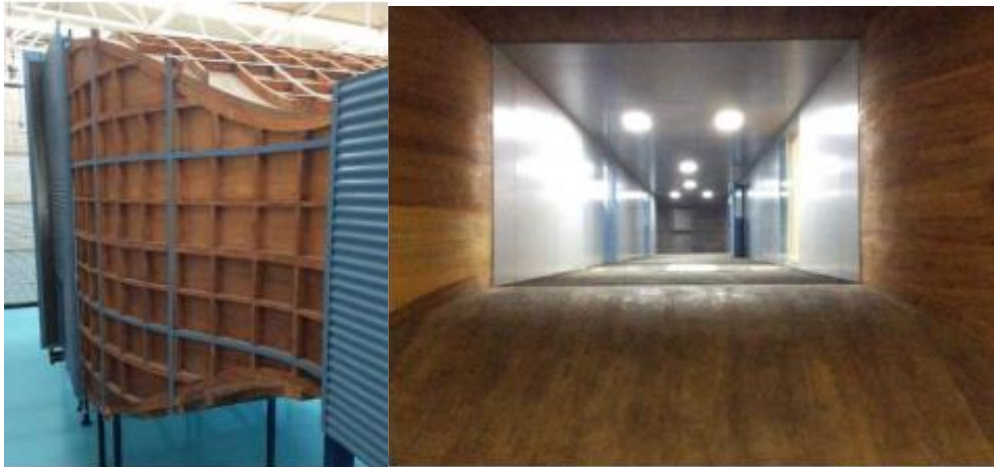
Figura 4.10 Cono de contracción visto desde fuera y dentro. Recuperado de: https://bit.ly/2PVA9YZ el 23 de mayo, 2019.
