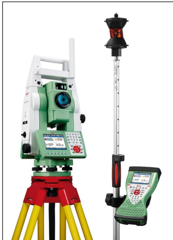
Figura 17. Estación total automatizada. Obtenida de https://www.instop.es/estatotales/estaciones-totales-robotizadas.php
