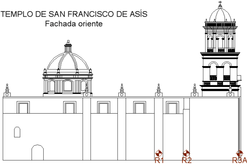
Figura 33. Localización de clavos de nivelación. Templo de San Francisco de Asís, fachada oriente.
