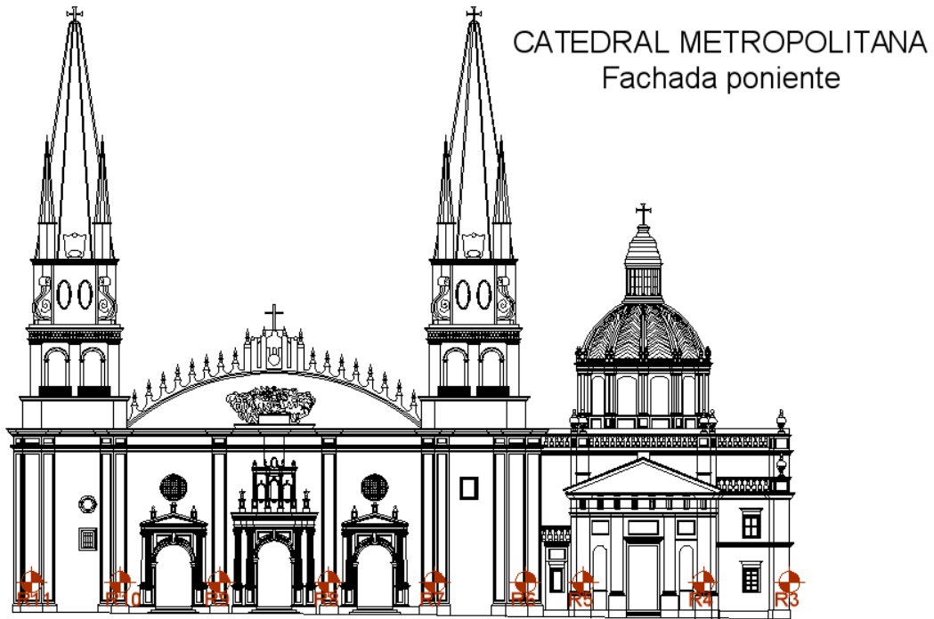
Figura 27. Localización de clavos de nivelación. Catedral Metropolitana, fachada poniente.
