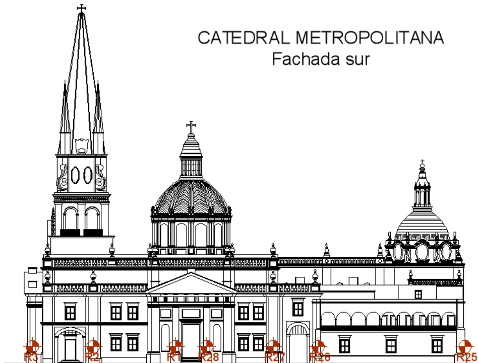
Figura 26. Localización de clavos de nivelación. Catedral Metropolitana (Sagrario), fachada sur.
