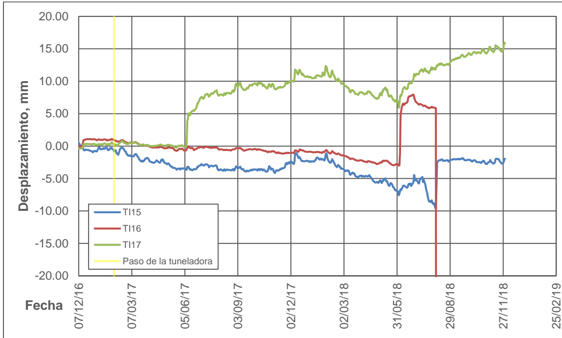
Figura 215. Desplazamiento Nte-Sur TI15, TI16 y TI17. Sagrario Metropolitano. Anomalía truncada.
