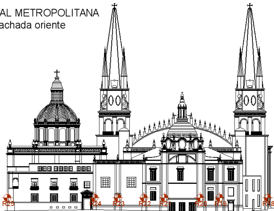
Figura 29. Localización de clavos de nivelación. Catedral Metropolitana, fachada oriente.
