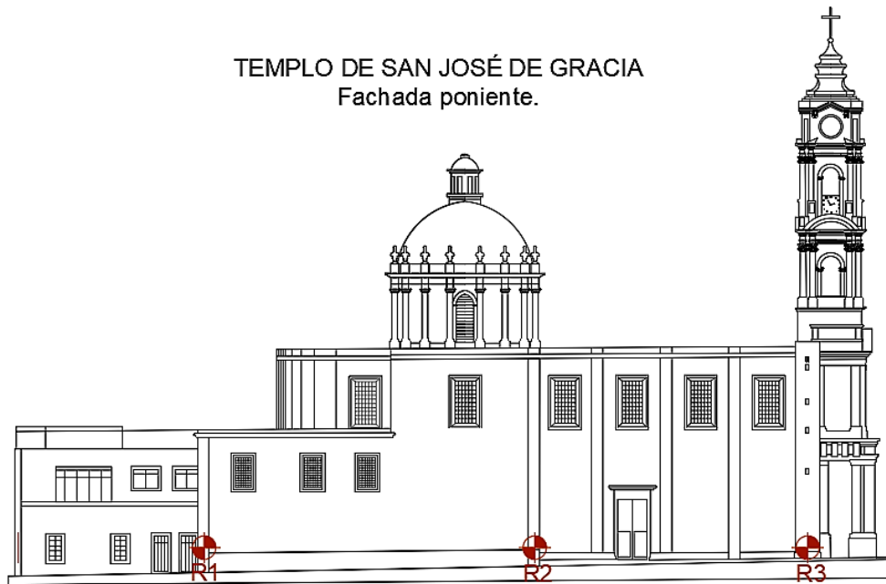
Figura 21. Localización de clavos de nivelación. Templo de San José de Gracia, fachada poniente.
