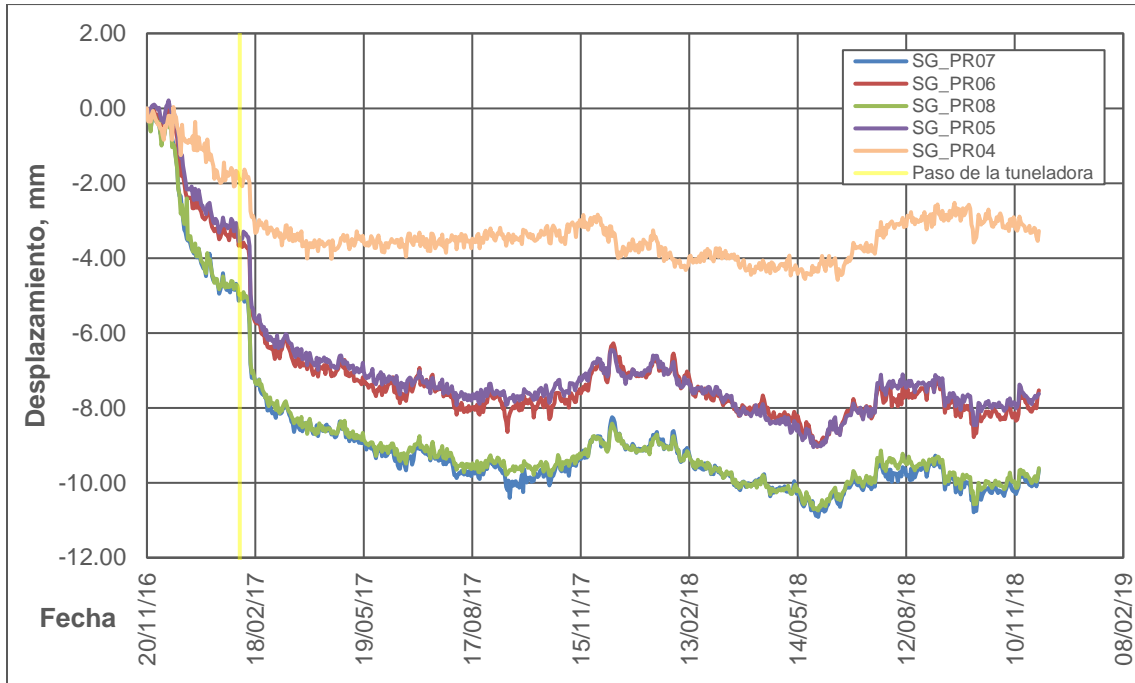
Figura 187. Asentamiento PR07, PR06, PR08, PR05 y PR04. Sagrario Metropolitano.
