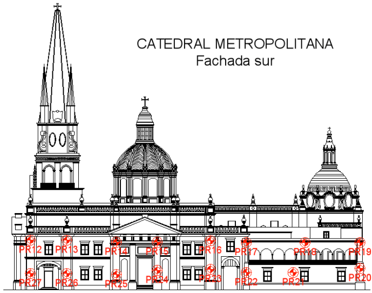
Figura 25. Localización de dianas reflectantes. Catedral Metropolitana (Sagrario), fachada sur.
