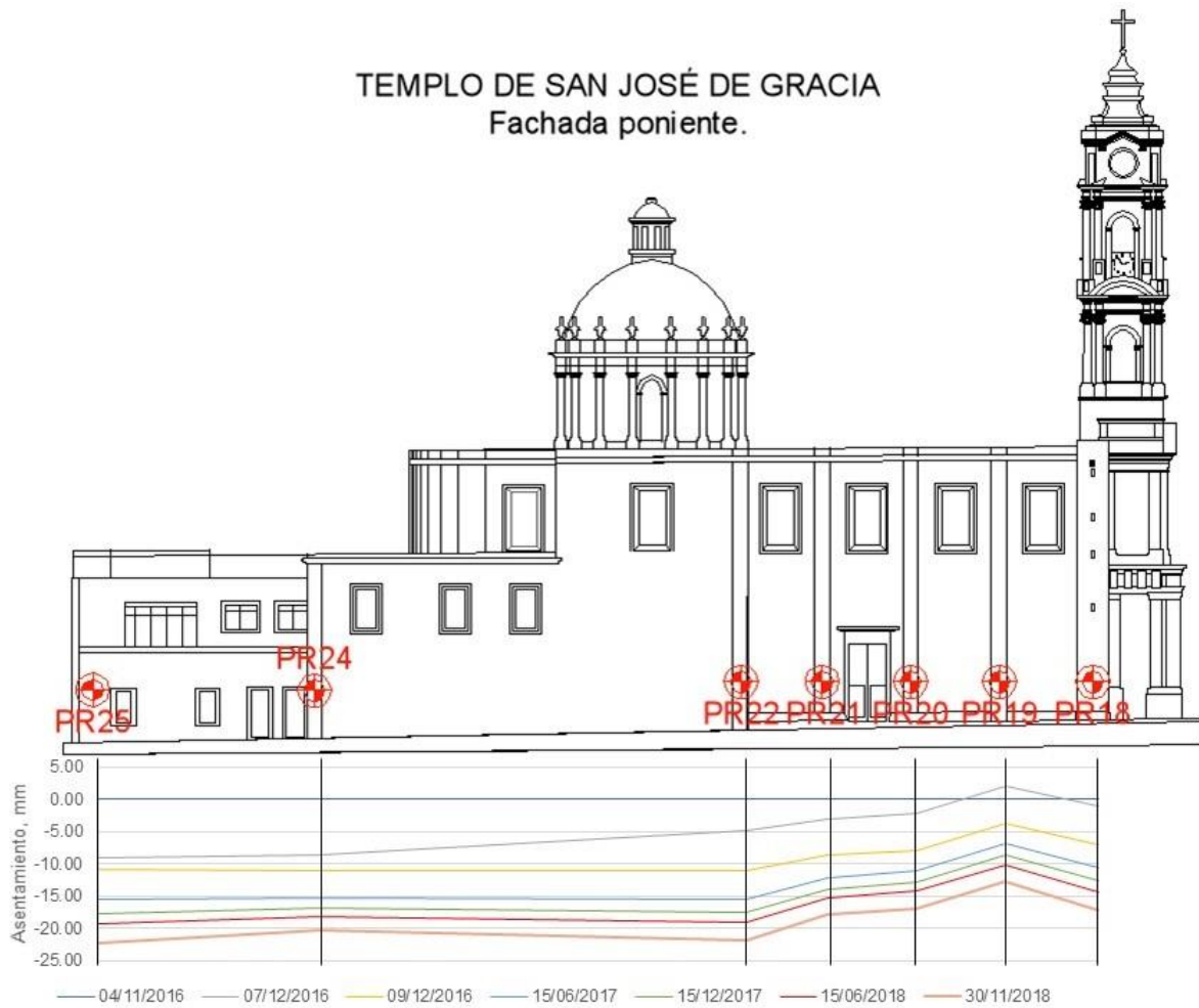
Figura 39. Perfil de asentamientos en fachada poniente. Templo de San José de Gracia.
